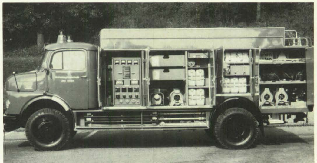
Für Arbeiten an Ölschadensstellen wurde dieser Universal-Gerätewagen mit einem fest eingebauten Stromerzeuger, einem 2 400 Liter fassenden Ölbehälter und Dachkästen zur Aufnahme verschmutzter Geräte konstruiert.
