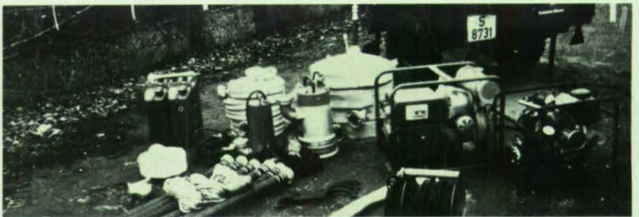
Zwei Tauchpumpen, eine TS 2/5 und ein Notstromerzeuger mit Material werden auf einen Zweirad-Anhänger geladen.
