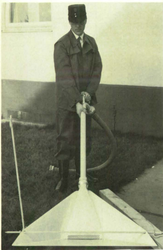
Vorführung eines Geräts zum Absaugen von Schwimmöl auf stehenden und fließenden Gewässern. Das an eine Pumpe angeschlossene Gerät wird zwischen Sperre und Ufer eingebaut und lagert einerseits auf der Sperre, andererseits auf einem Stützisen.
