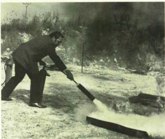
Mineralölbrände lassen sich nur schwer und nur unter besonderen Umständen mit Wasser löschen. Zu den geeigneten Löschmitteln gehören Schaum-, Pulver- und Kohlensäurelöscher, die wir hier bei der Anwendung im Bilde vorstellen.
