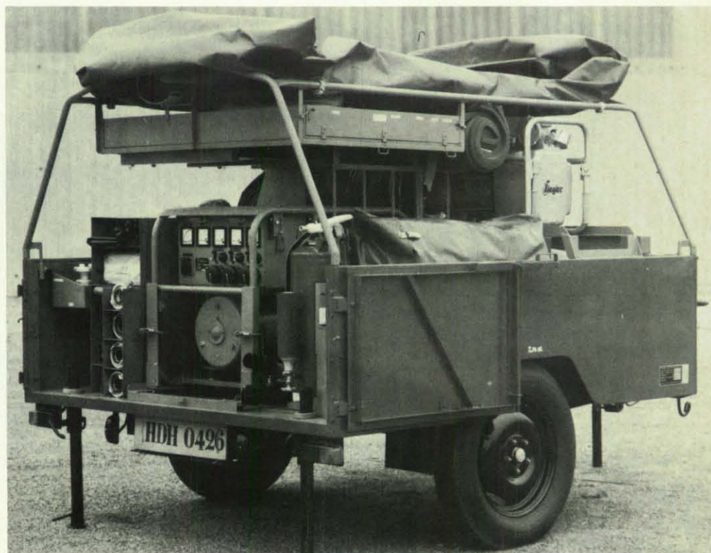
Dieser Ölschadenanhänger dient der Aufnahme der Grundausrüstung zur Hilfeleistung bei Tankwagenunfällen. Er besitzt eine gekröpfte Deichsel mit LKW-Zugöse und eine Handzugstange, die umgesteckt als vordere Stütze dient.
