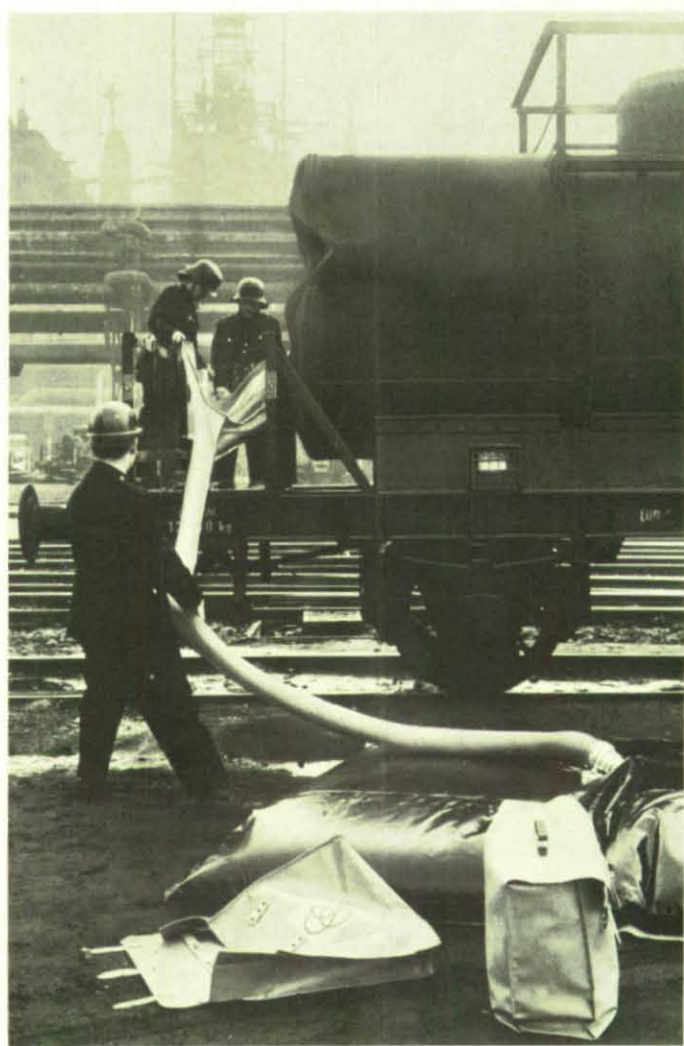
Tribut unserer Zeit an die hochtechnisierte Umwelt: Unfälle von Fahrzeugen mit gefährlicher Ladung. Aus einem defekten Tank auslaufendes Öl wird mit einer Kunststoffschürze aufgefangen und in einen angekuppelten Behälter geleitet.
