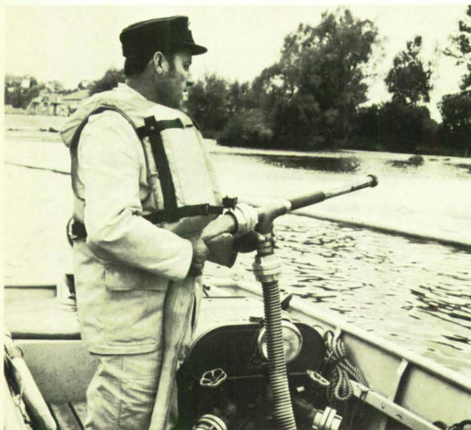
Um Ölbindemittel gleichmäßig und weiträumig auf die schwimmende Ölschicht zu verbreiten, werden von Arbeitsbooten aus Streugebläse und Zumischer (unser Bild) eingesetzt.
