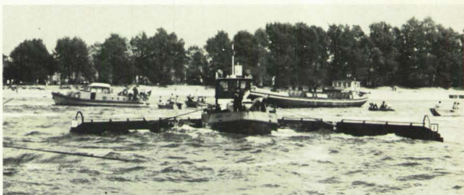
Das Ölfangschiff „LIBELLE“ der Bregenzer Ölwehr in voller Aktion. Es hat eine wirksame Breite von 20 Metern.
