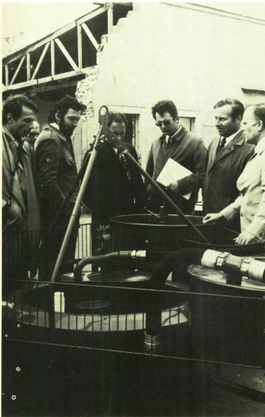
Ein transportables Ölabsauggerät vom Typ „Mainz-Mombach 1000 Z“, das von der Feuerwehr Lindau (Bayern) eingesetzt wurde, wird hier interessierten Zuschauern erklärt.
