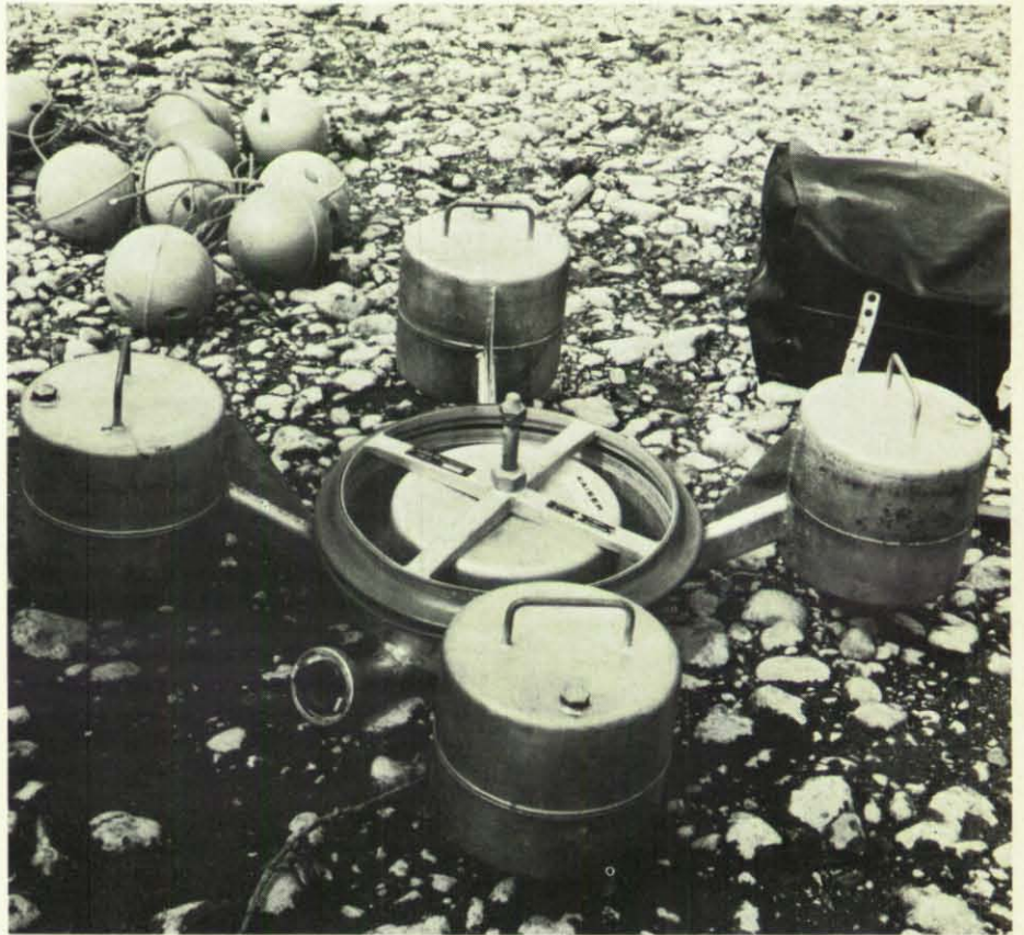
Unser Bild zeigt das „Kaiser-Ölabsauggerät Oela III“, das vor allem im Einsatzbereich der baden-württembergischen Ölwehren eingesetzt wurde.
