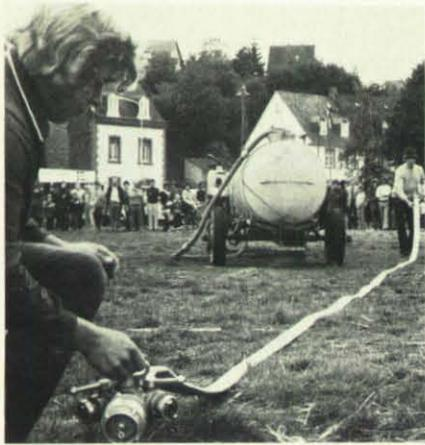
**Die Zapfwellenpumpe — eine wirkungsvolle Hilfe, wenn es um Brände in ländlichen Bereichen geht. Auch dieses Gerät wurde in Mayen praktisch vorgeführt.**
