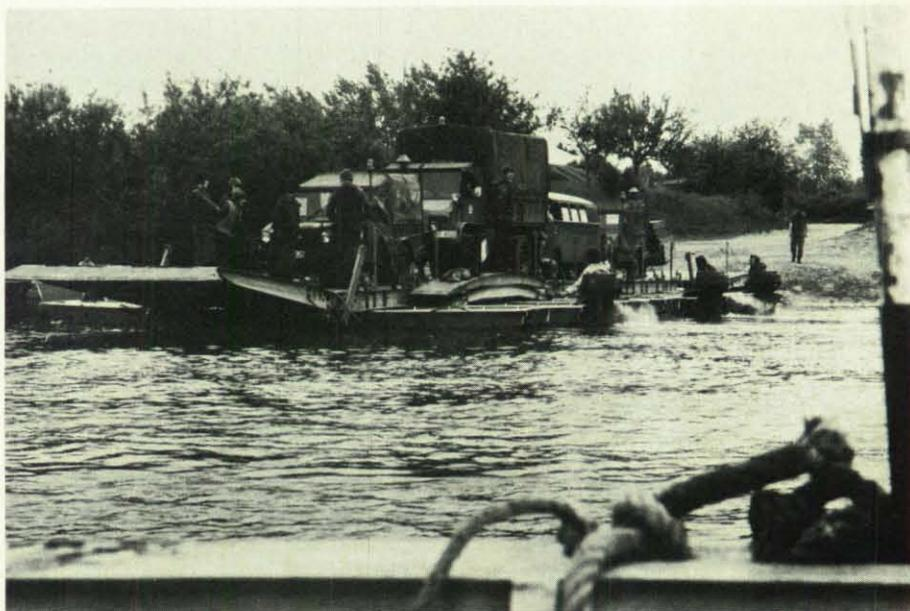
**Das THW ist in der Lage, Behelfsstege, Behelfsbrücken und Brückenfähren zu bauen und einzusetzen. Fähren als schwimmende Plattform und als Arbeitsbühne können bei allen Hilfsmaßnahmen wertvolle Dienste leisten.**
