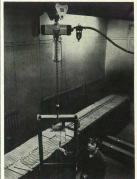
hubkraft dieser Hebezeuge z. B. den Traggrenzen der entsprechenden Hilfsmittel (Träger, Behälter etc.) angepaßt werden. Der größte Typ (1 t) wiegt einschließlich Haken und Kette nur 20 kg. Das Zubehör ist umfangreich und bringt als neue Bedienungsart eine Drehgriffsteuerung, die ein Verknoten der Steuerketten vermeidet und einen ermüdungsfreien Betrieb über lange Zeit erlaubt. Laufkatzen gibt es mit Verschiebe- und Druckluftmotorfahrwerk. H. F.
