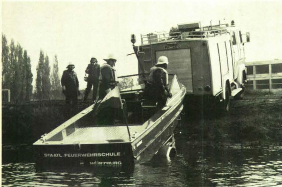
Für das Zuwasserbringen des K-Bootes sind sowohl für das Zugfahrzeug als auch für den Bootsanhänger befestigte Zufahrten notwendig.
