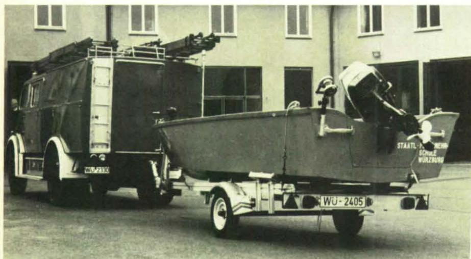
Das mit einem Außenbordmotor angetriebene A-Boot auf einem Anhänger. Das A-Boot kann wie ein K-Boot bestückt werden.
