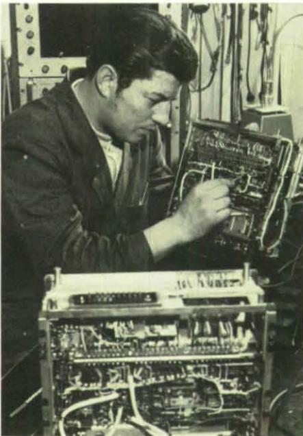
**Eine knifflige Aufgabe: Instandsetzung von Funkgeräten.**
