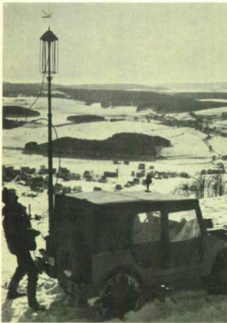
**Führungsfahrzeug des Fernmeldezuges während des Aufbaus des 6-m-Kurbelmastes.**
