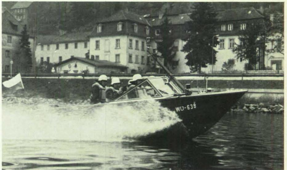
Der Antrieb des Bootes erfolgt über einen 130-PS-Marine-Motor, der eine Höchstgeschwindigkeit von 45 km/h ermöglicht.
