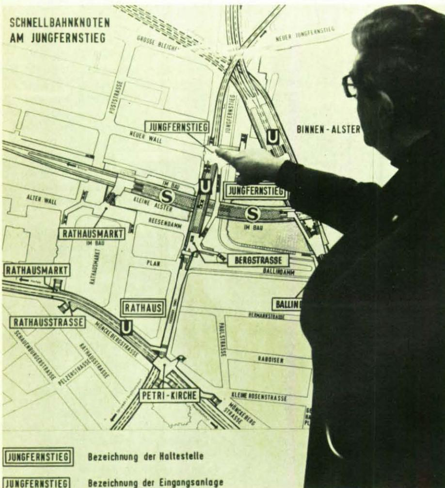
Schemaskizze des fünfgeschossigen Verkehrsknotens am Hamburger Jungfernstieg. Der Betrachter zeigt auf die Schalterhalle, die zum Schutzraum ausgebaut wurde.
