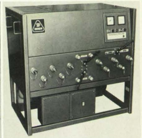
auf 300-bar gefüllt werden. Die unverwechselbaren Füllanschlüsse (mit Bauartzulassung) und das Sicherheitsschloß zur Umschaltung von 200- auf 300-bar bieten hohe Betriebssicherheit. Eine versehentliche Füllung von 200-bar-Flaschen mit 300-bar Überdruck ist also nicht möglich.
