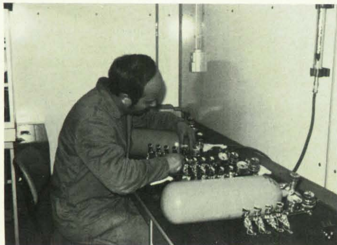
Überprüfung der Manometer am Druckminderer der Sauerstoffbehandlungsgeräte.
