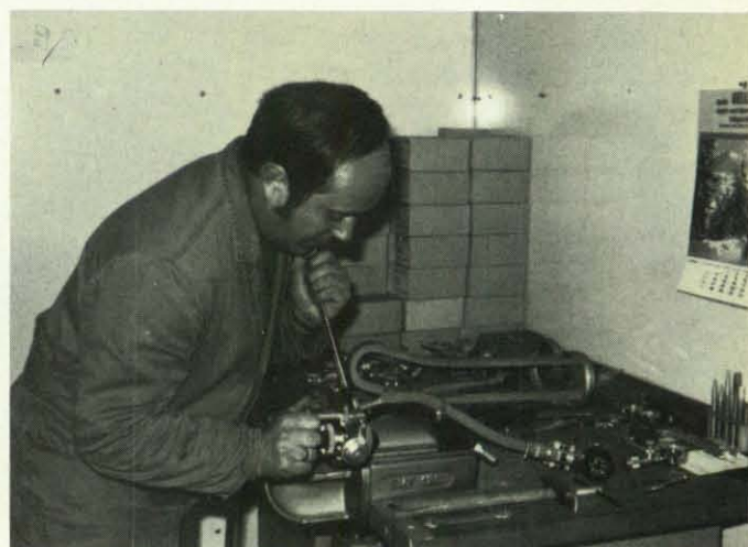
Anschluß der Druckmesserleitung an den überholten Druckminderer.
