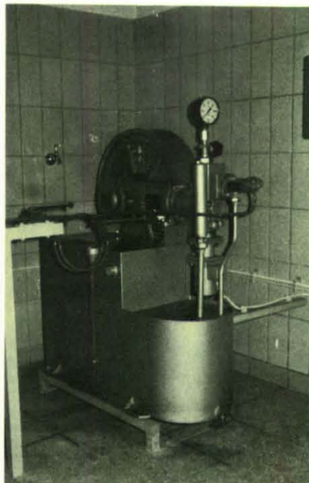
Einkolben-Druckpumpe (Betriebsdruck max. 600 bar) zum Abdrücken der mit Wasser gefüllten Druckgasflaschen.
