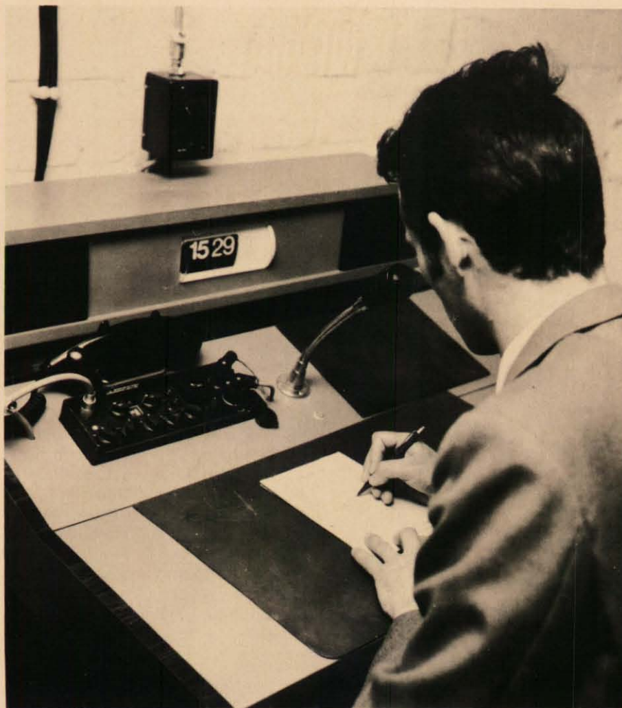
Arbeitsplatz eines Sprechfunkers am eingebauten Funkgerät FuG 7b.
