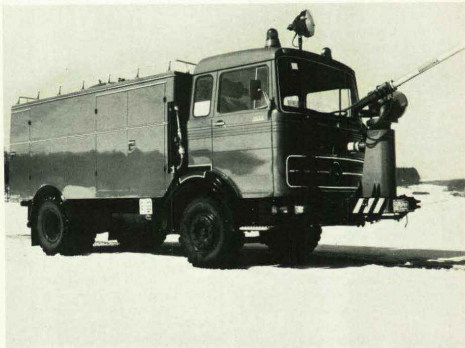
Nicht nur im Aufbau unterscheidet sich das Pulverlöschfahrzeug TroLF 4000 von früheren Konzeptionen; die gesamte Technik weist eine Reihe von Novitäten auf.
