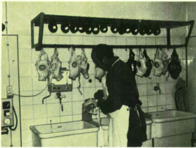
Reinigen und Trocknen der ABC-Schutzmasken im Montageraum.
