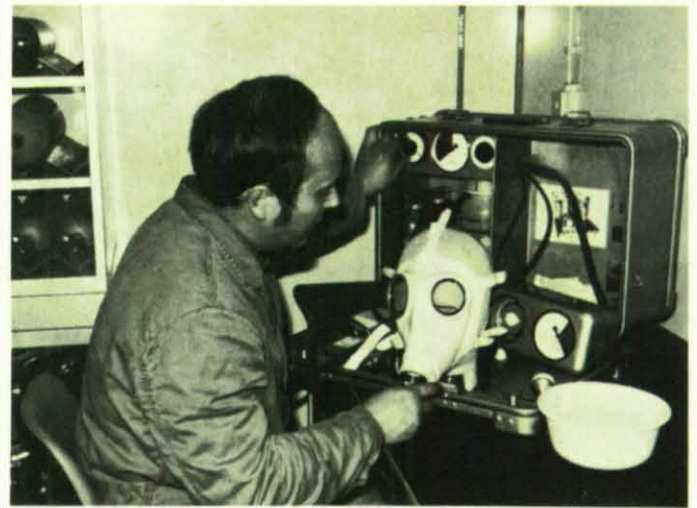
Prüfen der ABC-Schutzmaske im Maskendicht- und Ventilprüfgerät.
