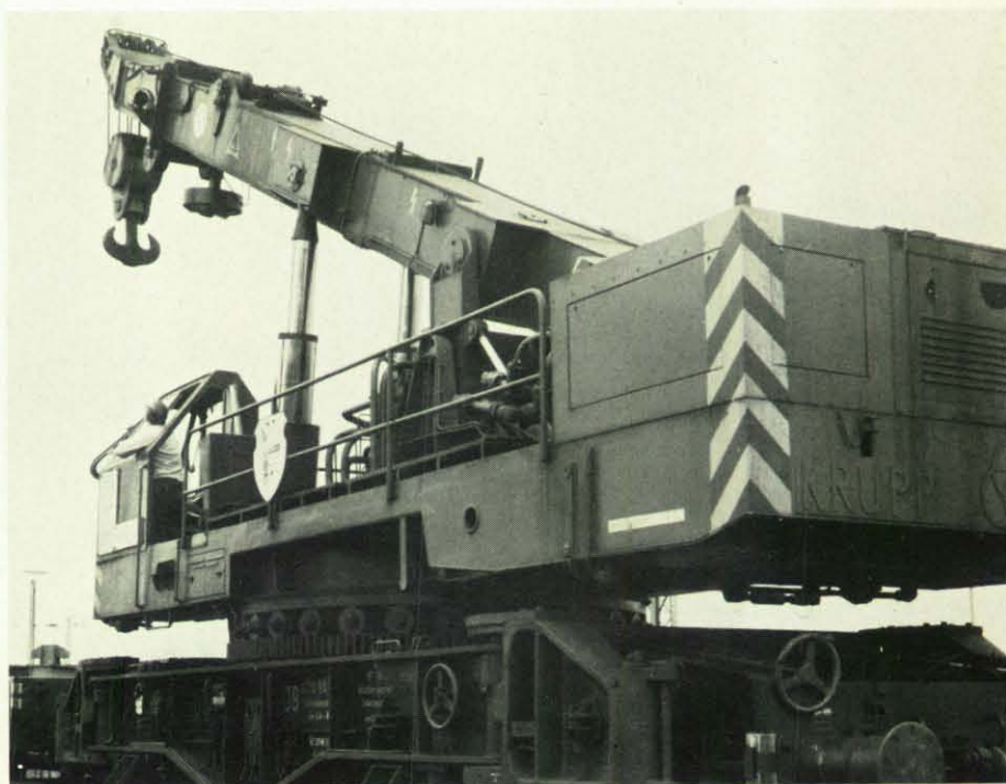
Ein moderner Teleskopkran der Bundesbahn. Seine Tragfähigkeit beträgt bei 6,60 Meter Ausladung 45 Tonnen.
