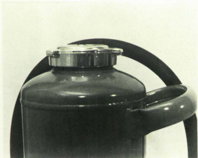
PG 6 H. Löschmittelbehälter mit schraubbarer Metallverschlußkappe. Sicherheitsventil in Verschlußkappe eingebaut. Ausführung für anliegende Treibmittelflasche. Tragegriff seitlich angeschweißt.
