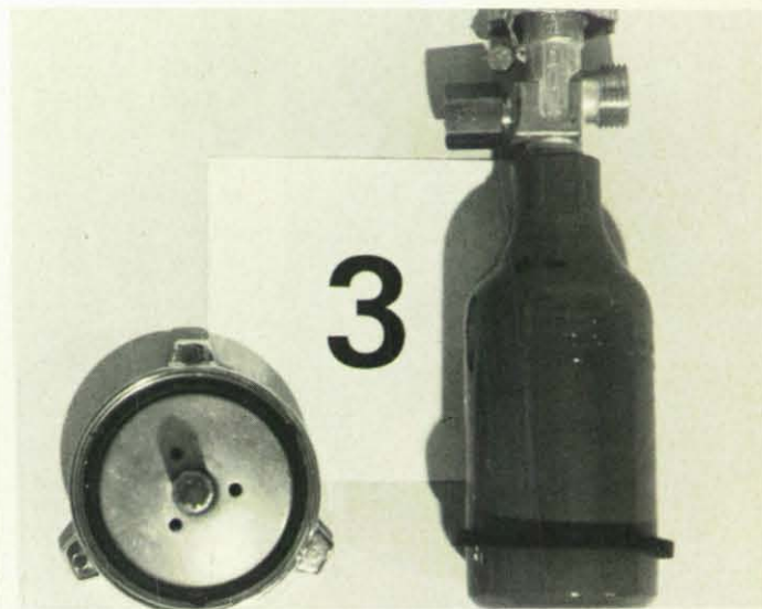
PG 6 H. Demontierte außenliegende Treibmittelflasche und Verschlußkappe. Flasche mit Drehventil und Handrad. Handrad mittels Plombendraht gesichert.
