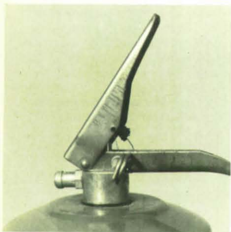
PG 12 H. Hebelarmatur mit Tragegriff aus Metall. Betätigungshebel mittels Splint gesichert. Diese Ausführung ist nicht mit einem Spritzschlauch versehen.
