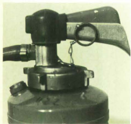
PG 6 H. Druckhebelarmatur mit Überwurf-Schraubring. Sicherungseinrichtung mittels Splint. Sicherheitsventil im Behälteroberteil. Spritzschlauch an der Druckhebelarmatur angeschlossen.
