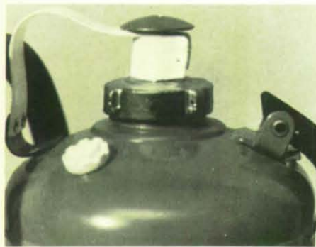
PG 6 H. Schlagarmatur mit aufschraubbarer Behälter-Verschlußkappe. Ausführung für innenliegende Treibmittelflasche. Sicherheitsventil im Behälterdeckel. Sicherheits-einrichtung besteht aus einer durch Plombendraht gesicherten Kunststoff-Lyraklemme.
