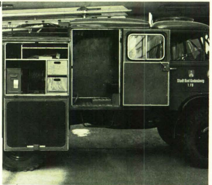
Bild 4 Geräteraum 4 enthält Greifzug 1,6 t mit Zubehör sowie u. a. Drahtseile und Steckstrickleiter.
