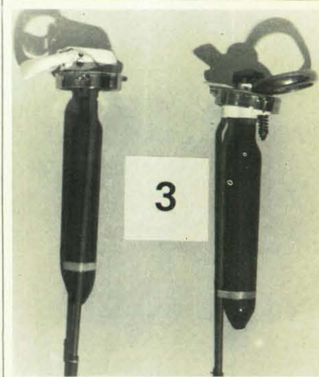
PG 6 H. Innenliegende Treibmittelflaschen mit Bedienungsmechanismen.
