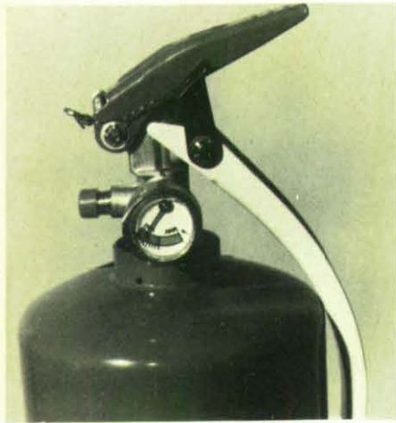
PG 2 L. Druckhebelarmatur aus Metall. Klappbarer Tragegriff. Angebautes Manometer. Hebel mittels Plombendraht gesichert.
