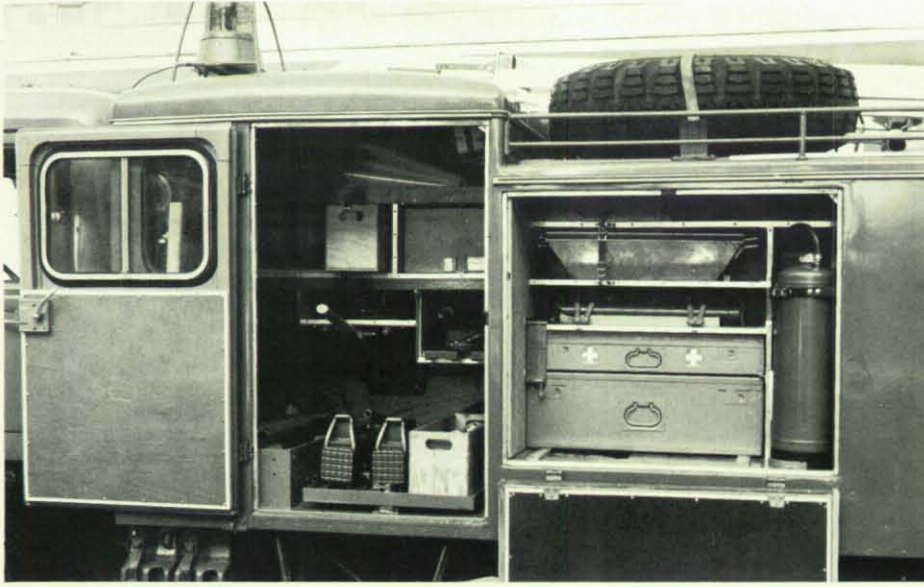
Geräteraum 1 (ehem. Mannschaftsraum): Auf dem Schubfach 2 hydraulische Winden (10 t Hubkraft) und 2 hydraulische Hebesätze (15 t Hubkraft). Geräteraum 2 mit geöffneter Klappe.
