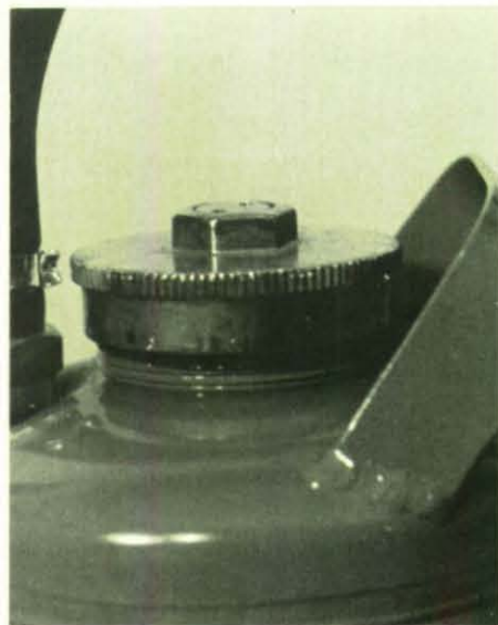
PG 6 H. Löschmittelbehälter mit aufgeschraubter Metallverschlußkappe. Angeschweißter Tragegriff. Spritzschlauch am Behälteroberteil angeschlossen. Sicherheitsventil in der Verschlußkappe eingebaut. Ausführung für außenliegende Treibmittelflasche.
