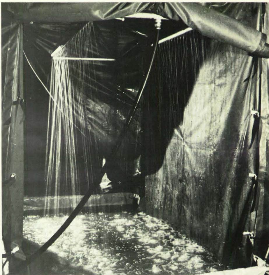
Die Duscheinrichtung ist so ausgelegt, daß etwa 50 Personen je Stunde dekontaminiert werden können. Handbrausen ermöglichen auch eine Teilkörperdekontamination.
