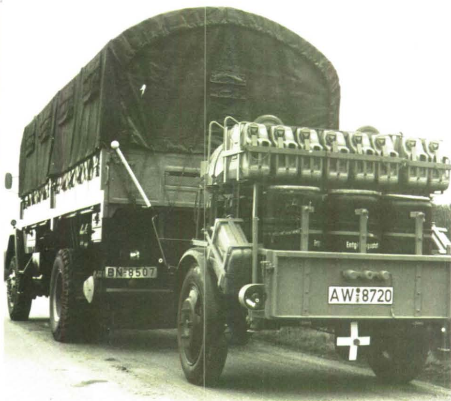
Auf dem Dekontaminations-Mehrzweckfahrzeug (DMF) ist die Dekontaminations- und ABC-Spürausstattung „Personal - Material - Gelände“ in Baugruppen verlastet.
