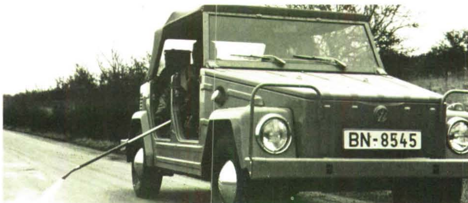
Die Vorteile dieses Spür-Kfz. liegen in seinem geringen Gewicht und in der einfachen robusten Bauweise. Spüraufträge können schnell durchgeführt werden. Die Dekontamination des Fahrzeugs ist relativ einfach.
