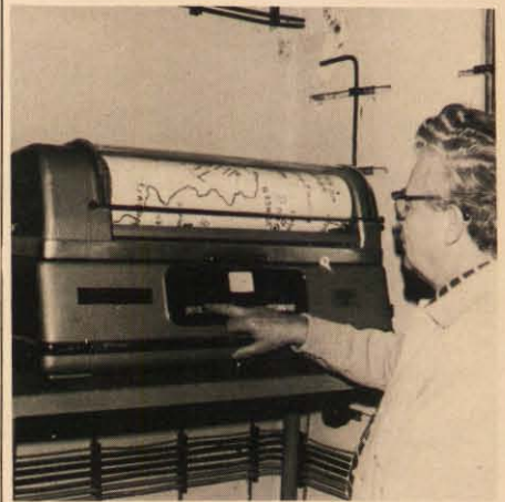
Ein interessantes Gerät für die Lehrgangsteilnehmer ist das Faksimile-Gerät des Warnamtes zur raschen Übermittlung von Kartenskizzen zur ABC-Lage.
