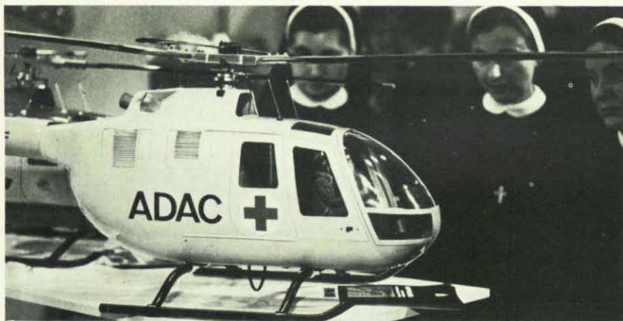
Das flugfähige Modell des Rettungshubschraubers BO 105 kann 20 Minuten in der Luft bleiben.
