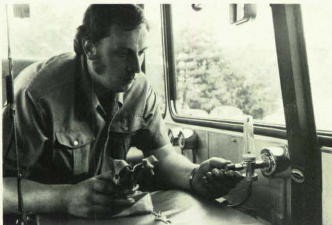
An die 29 Sauerstoffsteckdosen, hier mit Dosiereinrichtung, können ebensoviele Patienten gleichzeitig über Inhalationsmasken angeschlossen werden.
