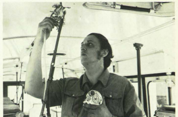
An diesen Sauerstoff-Vierfachverteiler lassen sich zwei Pulmotoren zur Wiederbelebung, eine Sekretabsaugvorrichtung und eine Inhalationsmaske anschließen.
