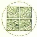
Abb. 20 Kreuzholz: Querschnittsfläche größer als 32 cm 2 und aus Langholz Rahmen: Mindestens 4 Stück aus Rundholzabschnitten Kreuzholz
