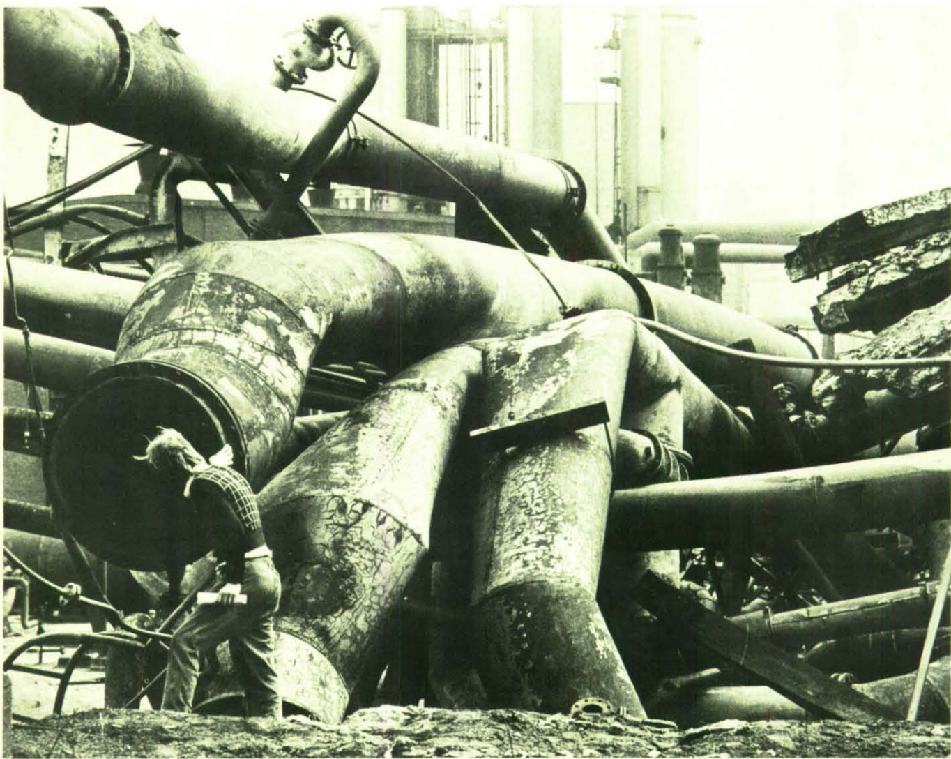
WIE GEKNICKTE HALME sahen diese Gasleitungsrohre nach einer schweren Explosion auf der Kokerei der Zeche „Gneisenau“ in Dortmund-Derne aus, bei der zwei Menschen ums Leben kamen. Werks- und Berufsfeuerwehr konnten ein Übergreifen der Flammen auf einen in der Nähe stehenden Gasometer verhindern.
