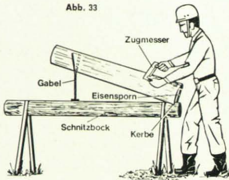
Weißschälen mit Zugmesser und Schnitzbock
