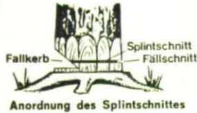
Anordnung des Splintschnittes
