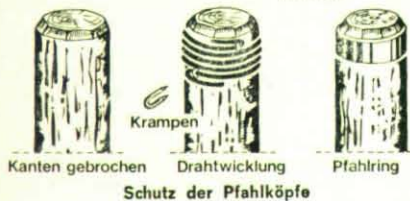
Schutz der Pfahlköpfe
