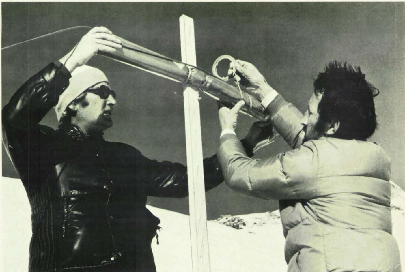
Anbringen des Sprengsatzes für eine Schneefeldsprengung. Diese Sprengmethode arbeitet nach dem Luftminenprinzip. Bei der Explosion des Sprengsatzes wird die Schneedecke zunächst angedrückt (Druckwirkung) und mit dem Sog (Sogwirkung) zum Abgleiten gebracht.
