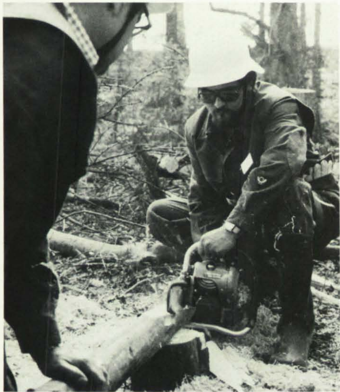
Der Gebrauch einer Ein-Mann-Motorsäge ist schon eine große Arbeitserleichterung, denn Bergungsdienst ist in hohem Maß eine technische Aufgabe. Das Gerät wird zum Schneiden von Bohlen und Balken, zum Fällen von Bäumen und zum Trennen von Holzkonstruktionen benutzt.
