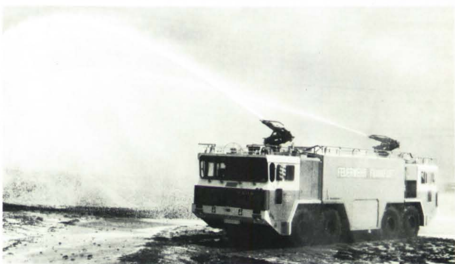
Ein Großtanklöschfahrzeug der Frankfurter Feuerwehr kann sowohl bei Flugzeugunglücken als auch bei Raffinerie-Großbränden eingesetzt werden. Das Fahrzeug kann von zwei Fahrerkaniblen aus gefahren und bedient werden.
