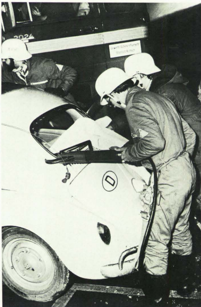
Die Hydro-Schere ist eines der wichtigsten Hilfsmittel für die technische Hilfeleistung bei Verkehrsunfällen.
