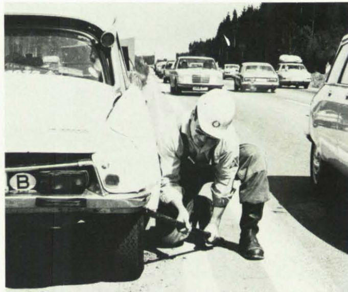
Bei leichten Blechschäden hilft die Brechstange, das Fahrzeug wieder rollfähig zu machen.
