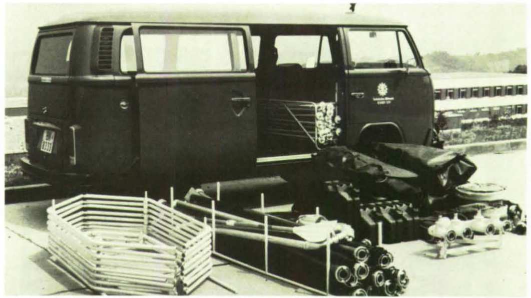
Bild 2: VW-Kombi mit Zubehör zur mobilen Trinkwasseraufbereitungsanlage
