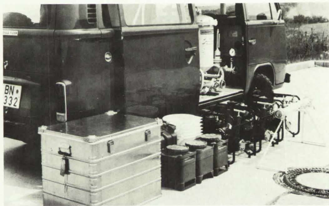
Bild 1: Mobile Trinkwasseraufbereitungsanlage, in VW-Kombi verlastete Standardausrüstung, ergänzt durch 3 Kunststoffbehälter für Chemikalien
