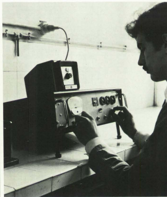
Ausbildung am Strahlenmeßgerät. Der Zivilschutz hat im ganzen Land Meßstellen eingerichtet, die für die Überwachung der Luft auf Radioaktivität mit entsprechenden Meßgeräten ausgestattet wurden.
