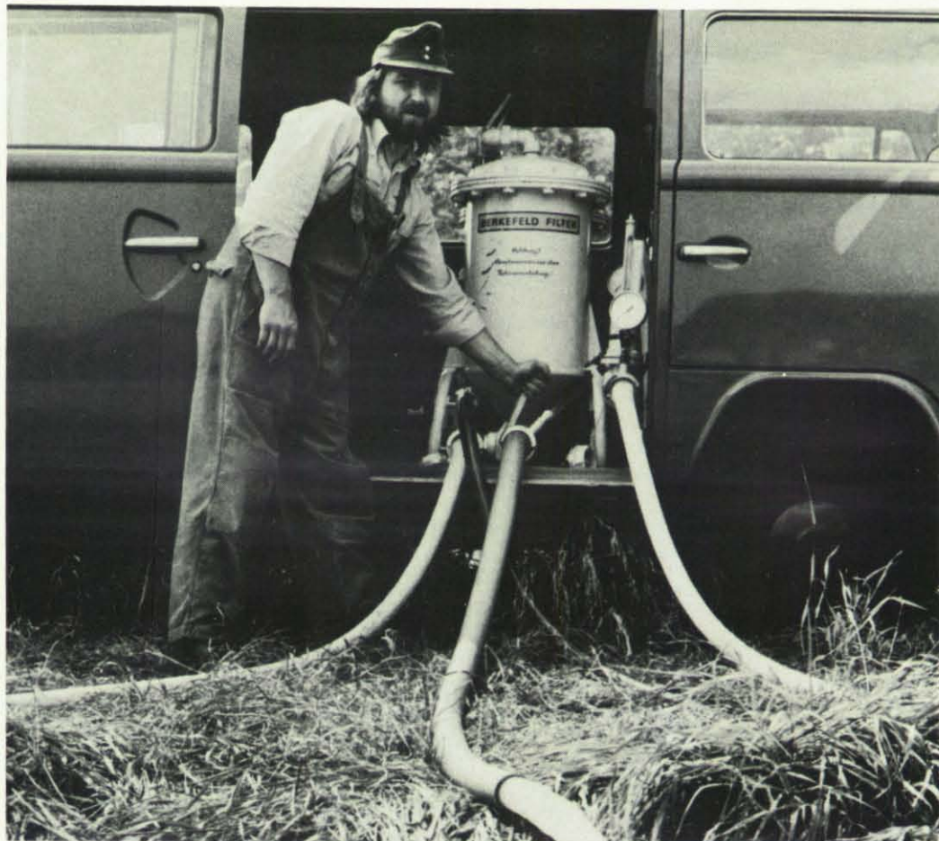
Bild 9: Rückspülen eines Anschwemmfilters.
