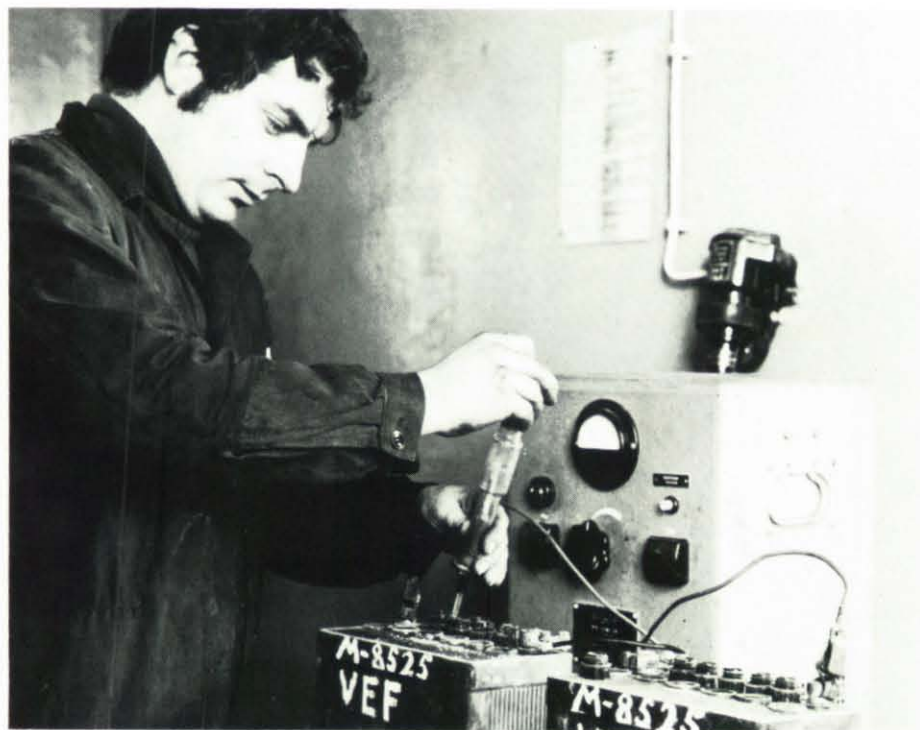
Überprüfung der Säuredichte, die ein Maß für den Ladezustand ist.
