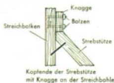
Verbolzte Knagge am Kopfende der Strebstütze
