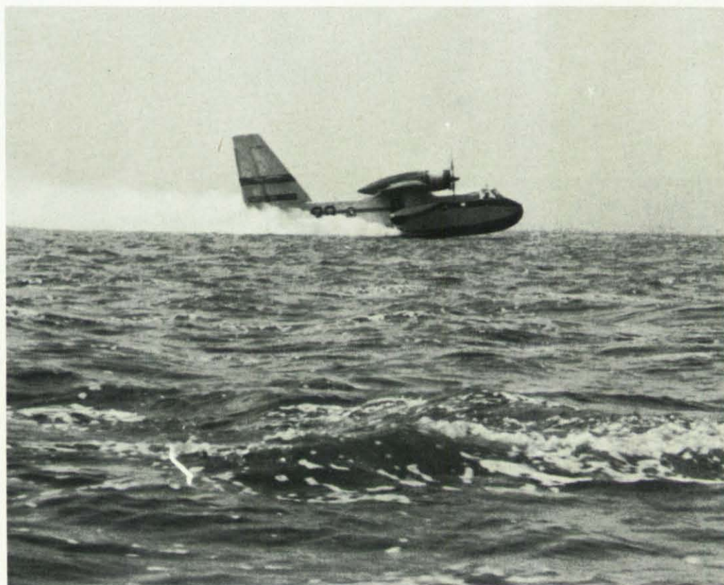
Zum Auftanken der Wasserlast von 5,5 Tonnen gleitet die Maschine mit einer bestimmten Geschwindigkeit über das Wasser. Dabei füllen sich die Tanks innerhalb von 12 Sekunden. Danach startet der Pilot die Maschine wieder durch und fliegt zum Einsatzort.
