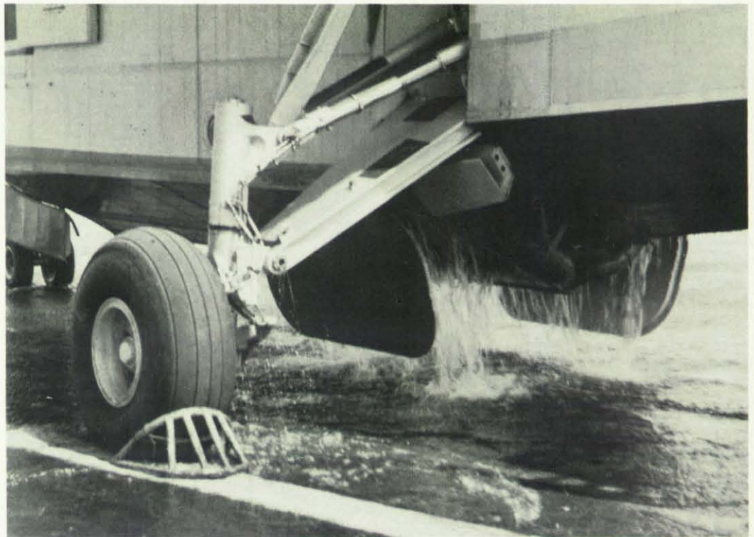
Wenn sich diese beiden Klappen öffnen, verläßt das Wasser die Tanks. Das auf unserem Bild entströmende Wasser stammt von der Reinigung der Tanks, bei der nach einem Einsatz aggressive Seewasserreste herausgespült werden.
