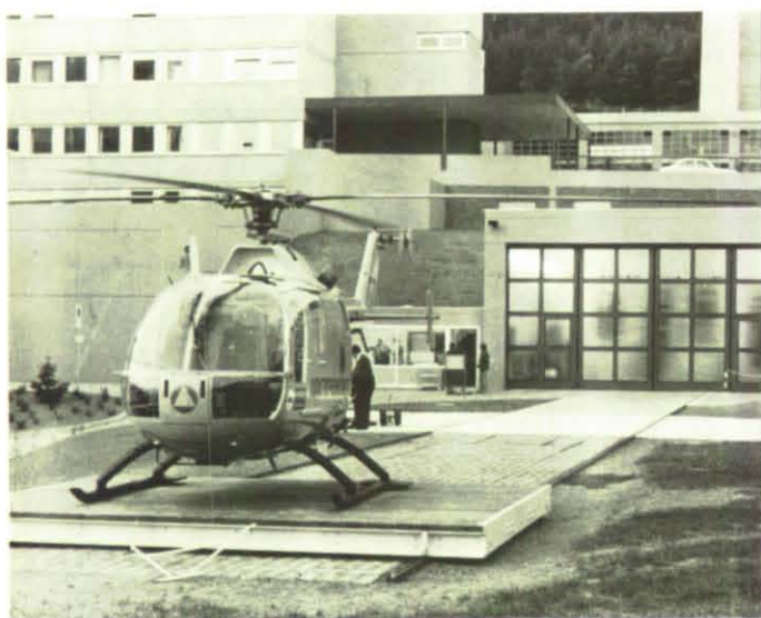
Die Start- und Lande-Plattform auf Schienen, auf der „Christoph 10“ in den Hangar (im Hintergrund) geschoben werden kann.
