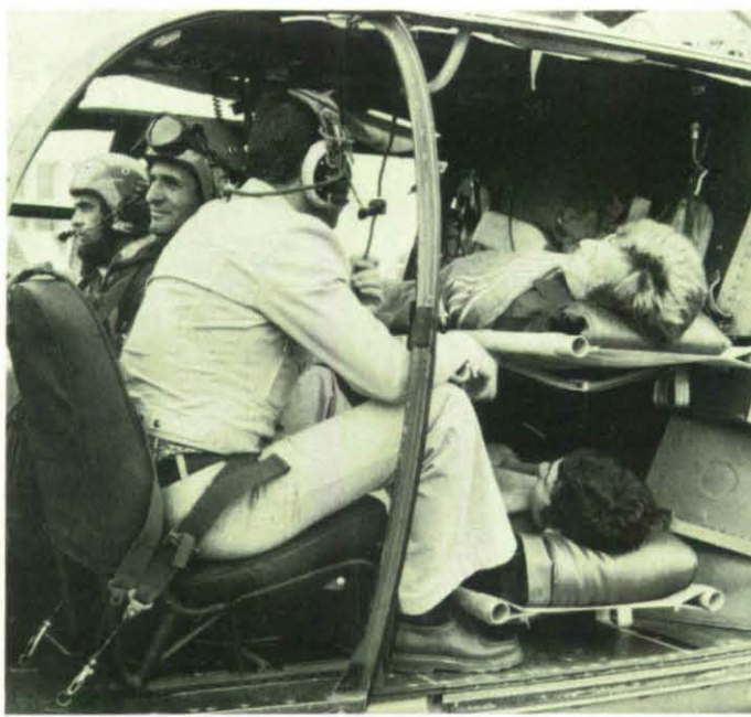
Die Besatzung setzt sich aus einem Piloten, einem Mechaniker und einem Beobachter zusammen. Hinter ihren Sitzen können zwei Tragen mit Verletzten untergebracht werden.
