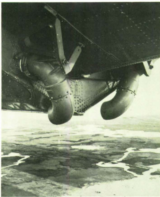
Über diese beiden unter dem Rumpf angebrachten Rohre wird das Wasser durch die Fahrgeschwindigkeit in die Tanks gedrückt, wo besondere Ventile dafür sorgen, daß es nicht ungewollt wieder herausläuft.
