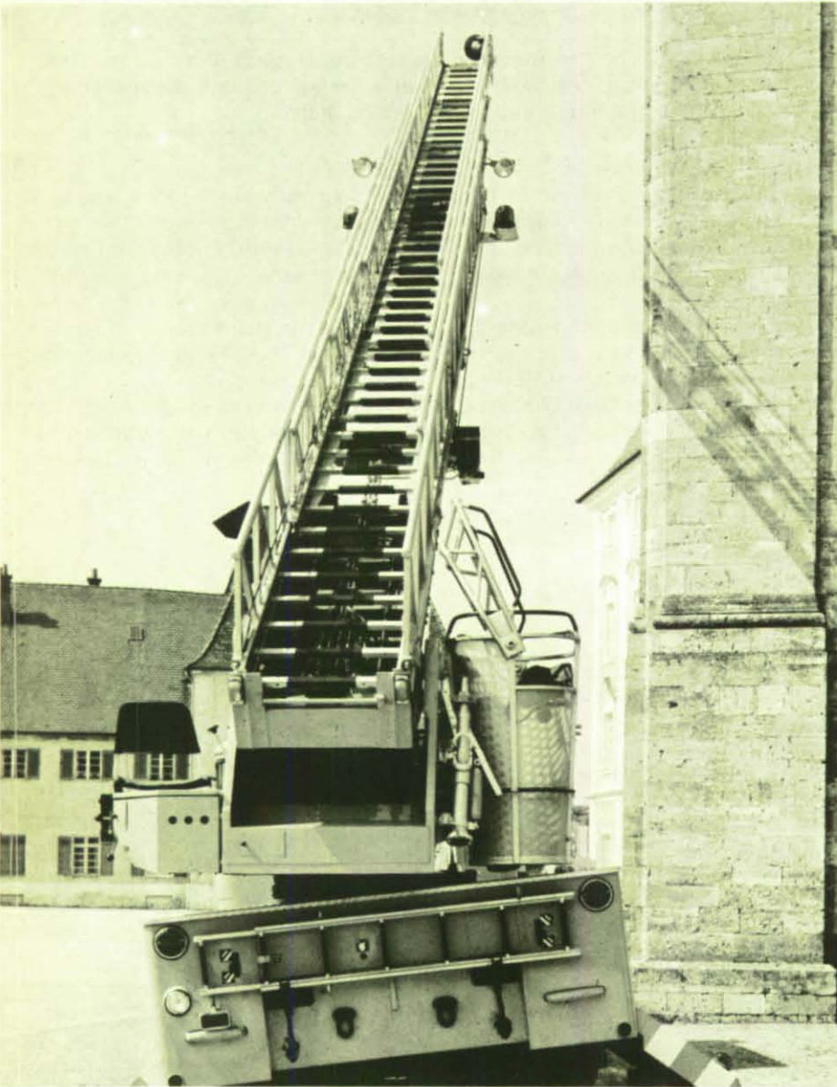
Leitersatz und hinteres Drehgestell können durch Hydraulik-Zylinder vertikal bis zu 7° nach rechts und links geschwenkt werden. Hierdurch bleiben die Sprossen auch bei schräg stehendem Fahrzeug und bei jedem Aufrichtwinkel automatisch in der Waagerechten.
