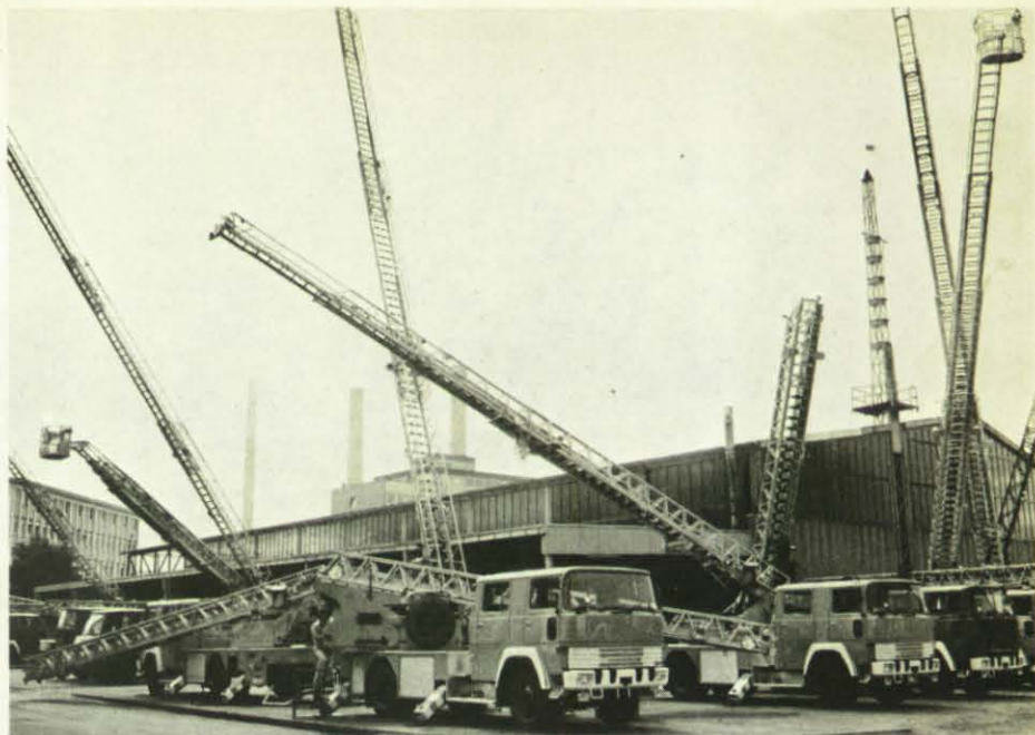
Heute: Erprobung von Feuerwehrdrehleitern bei Magirus-Deutz. Unser Bild zeigt ausgefahrene, geschwenkte und unterflur gerichtete Leitern mit verschiedenen Steighöhen mit und ohne Rettungskorb.
