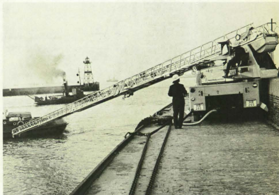
Feuerwehrleitern müssen nicht immer in den Himmel ragen. Bei einem Wasserrettungseinsatz in Bremen wurde die Möglichkeit, die Leiter bis -15^\circ unter Fahrbahnniveau auszufahren, voll genutzt.
