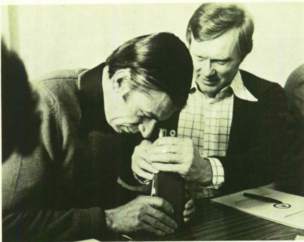
Der eingebaute kleine Kondensator muß vor Gebrauch des Geräts mit Hilfe eines handlichen Ladegeräts auf einige hundert Volt aufgeladen werden. Ein Drehknopf erlaubt es, die Aufladung so einzustellen, daß der Quarzfaden auf der Nullmarke steht.
