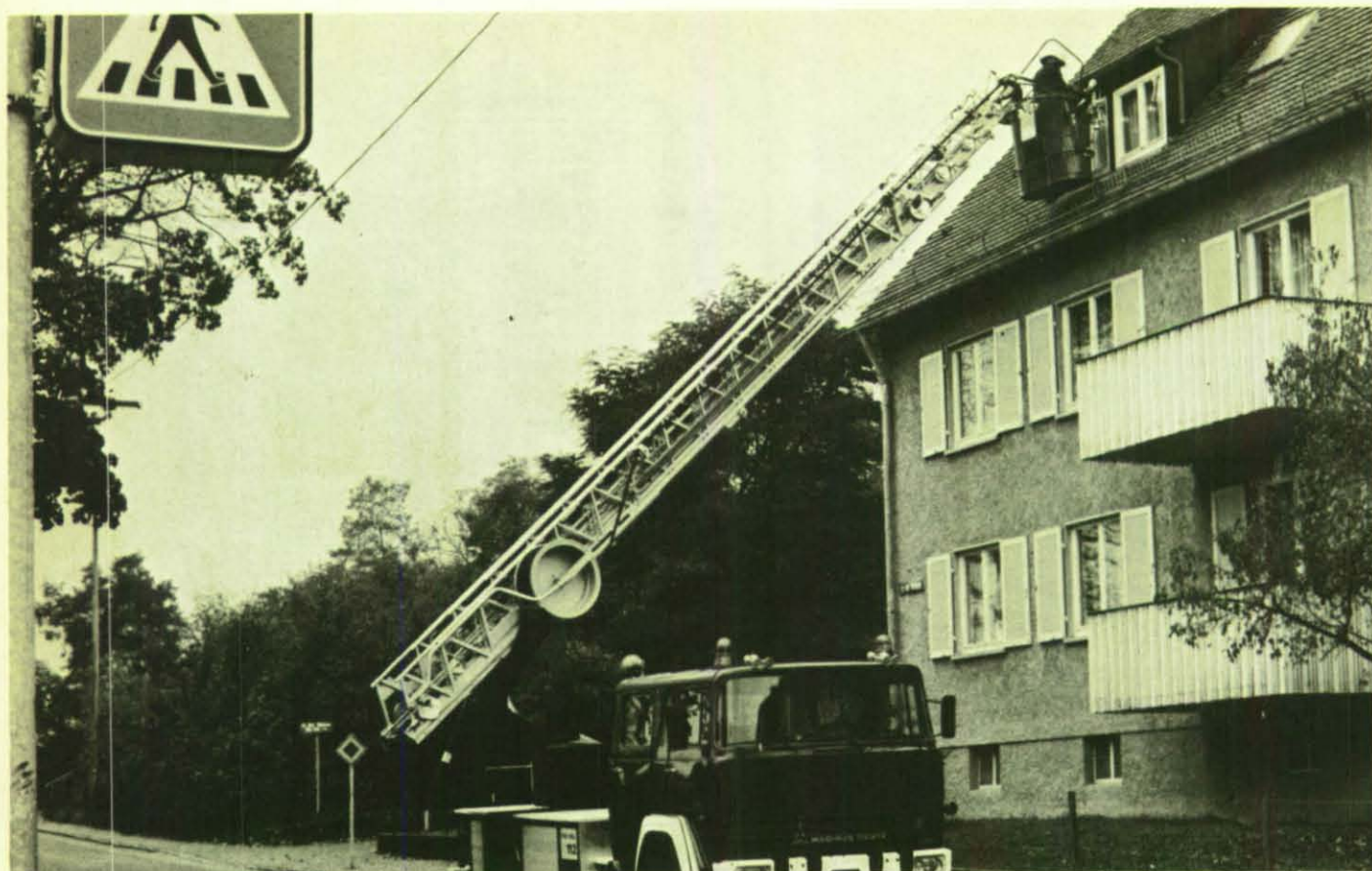
Eine der 232 PS (171 kW) starken Drehleitern, die an die Stuttgarter Berufsfeuerwehr geliefert wurden, zeigt, wie mit dem zwangsgesteuerten, hängenden Rettungskorb an Mansarden und Dachaufbauten gefahren werden kann. Ohne Schwierigkeiten können in Not geratene Menschen in den Rettungskorb umsteigen.
