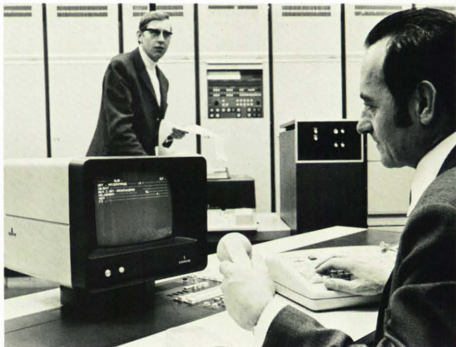
Einsatzleitreechner. Im Vordergrund: Datensichtgerät und Eingabetastatur.
