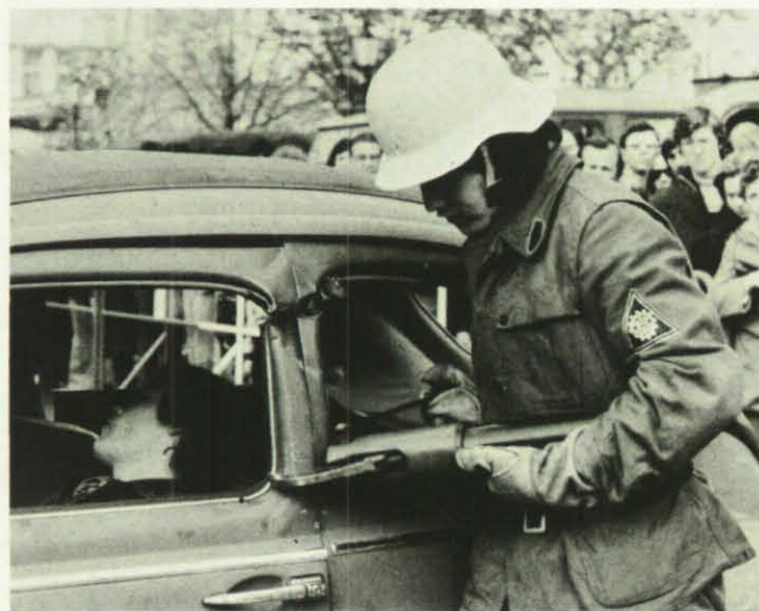
Demonstration einer Unfall-Rettungsschere, die als Hydro-Schneider mühelos Tür- und Fensterrahmen von Pkw zerschneidet und damit zu einem wertvollen Rettungsgerät wird.
