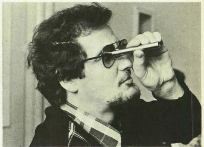
Wenn man durch das Rohr des Taschendosimeters schaut, sieht man auf der Skala einen feinen metallisierten Quarzfaden, der sich, entsprechend der Ladung des Kondensators, auf einen bestimmten Zahlenwert einstellt. Die Skala ist in rad geeicht.
