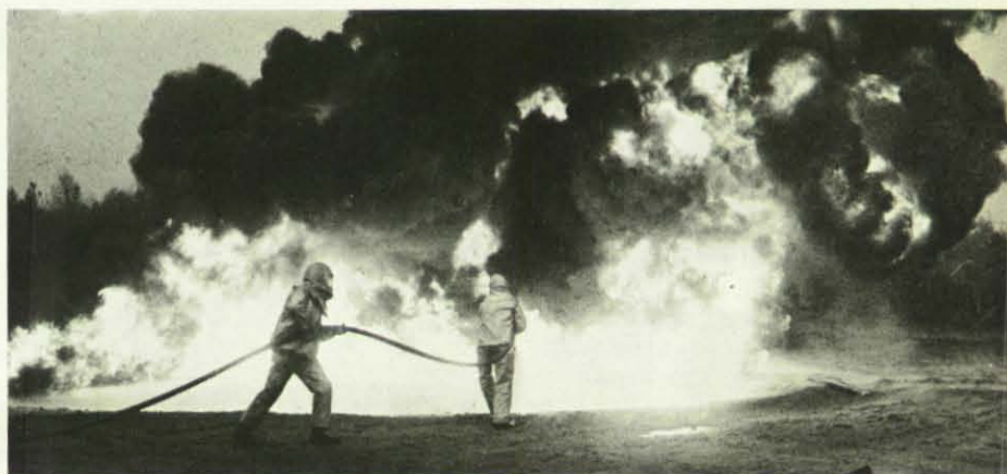
Hier brennen 5 000 Liter Benzin auf einer Fläche von 200 m 2 . Nach 60 Sekunden Vorbrennzeit beginnt ein Mann mit einem Rohr und dem Schwerschaum Light Water mit dem Löschen. Der zweite Mann im Bild hilft lediglich den Schlauch ziehen.
