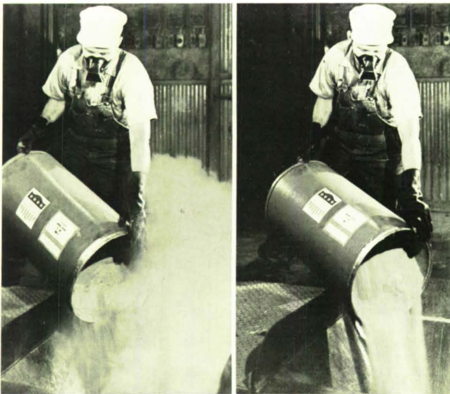
Brand- und Explosionsgefahren sowie gesundheitliche Störungen durch das Einatmen giftiger Staubteilchen soll in Industriebetrieben ein neuartiges Staubbindemittel abwenden. Die Vergleichsaufnahmen zeigen links den Umgang mit einem unbehandelten Stoff und rechts das Schütten nach einer Behandlung mit dem Staubbindemittel.
