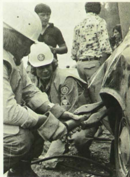
Einsatz eines Hydrospreizergerätes bei einem Verkehrsunfall auf der Bundesautobahn.
