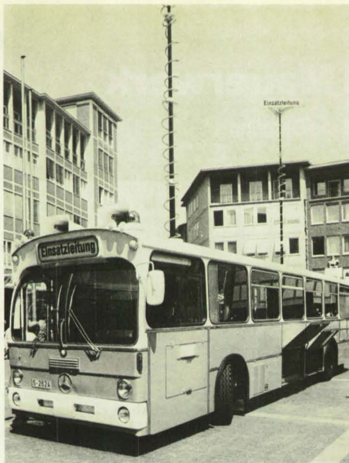
Bild links: In den Kofferräumen untergebracht sind u. a.: Notstromaggregat, Batterien, Transformatoren, Kabeltrommeln. Auf dem Dach die ausfahrbaren Licht- und Antennenmasten. Rechts: Zur technischen Ausstattung des Fahrzeugs gehört u. a. auch dieser Funktisch mit Funk- und Fernsprechvermittlung und einer Anlage für Lautsprecherdurchsagen.
