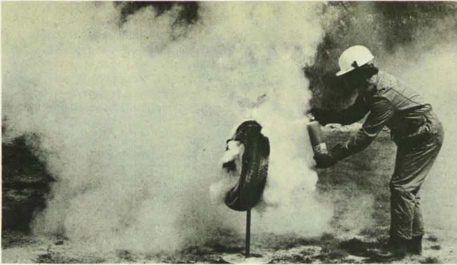
Einen brennenden Autoreifen mit tiefsitzenden Glutnestern abzulöschen, ist gar nicht so leicht. Da reicht oft ein einziger mit Hochleistungspulver gefüllter Feuerlöscher nicht aus.
