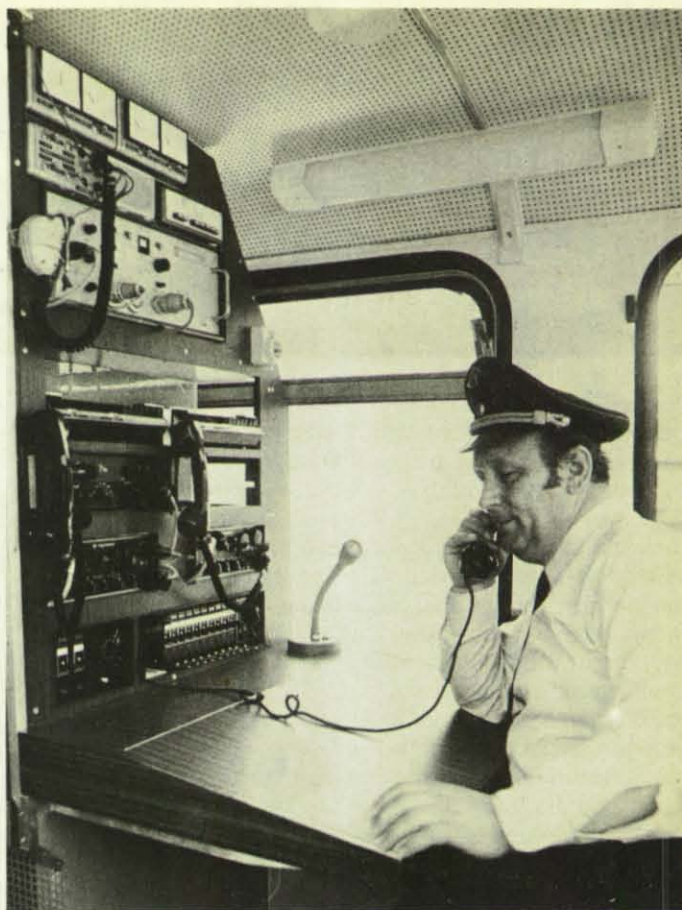
Bild links: In den Kofferräumen untergebracht sind u. a.: Notstromaggregat, Batterien, Transformatoren, Kabeltrommeln. Auf dem Dach die ausfahrbaren Licht- und Antennenmasten. Rechts: Zur technischen Ausstattung des Fahrzeugs gehört u. a. auch dieser Funktisch mit Funk- und Fernsprechvermittlung und einer Anlage für Lautsprecherdurchsagen.
