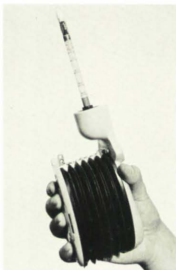
Saugpumpe mit aufgesetztem Prüfröhrchen
