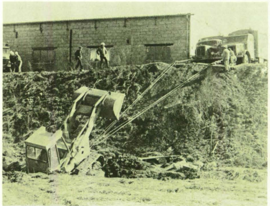
Mit einer GKW-Seilwinde und drei Greifzügen gelang den THW-Helfern des OV Freisen die Bergung der 13 Tonnen schweren Planierraupe.
