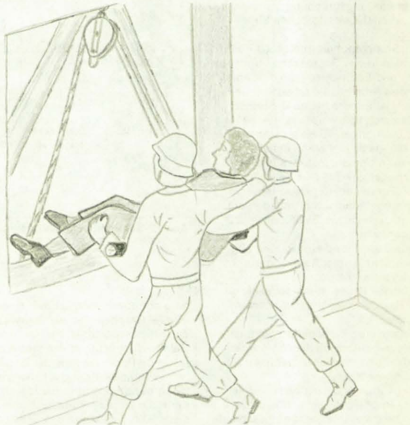
Abb. 4: Zwei Helfer legen den „Sitzriegel mit Sicherungsschlaufe“ der zu bergenden Person an und heben sie über die Fensterbrüstung.
