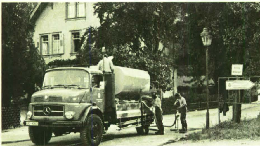
Der 5000-Liter-Tank wird mit Wasser aus dem Unterflurhydranten neu gefüllt.
