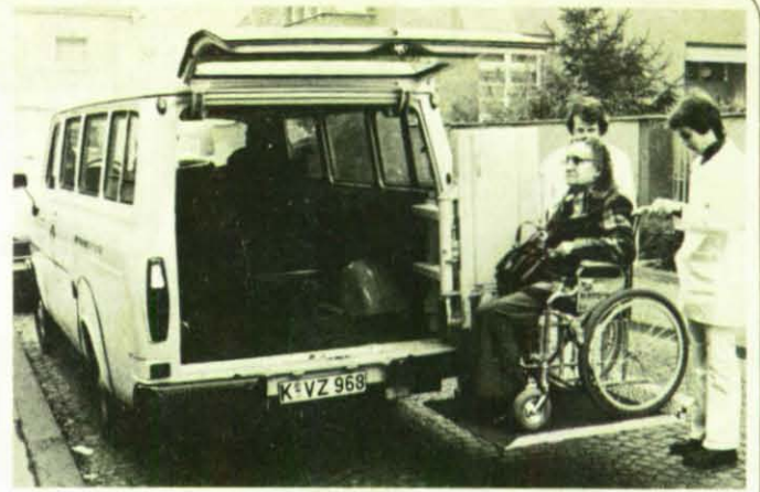
Bild links: Behutsam fährt der Helfer den Rollstuhl mit einer Schwerbehinderten bis an die Hebebühne. Rechts: Hydraulisch wird die Hebebühne bis auf die Ebene des Behinderten-Taxi angehoben.
