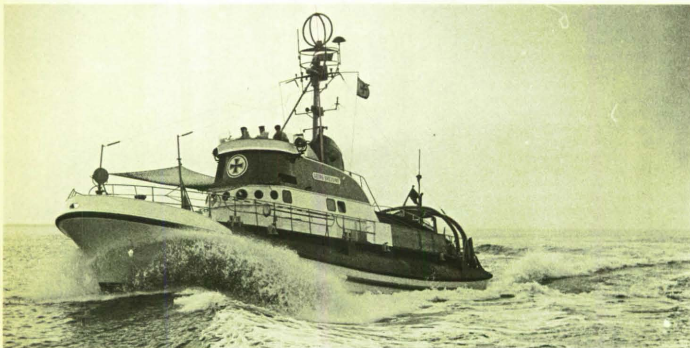
Seenotkreuzer „Georg Breusing“, 26 m lang, 5,6 m breit, 1,6 m Tiefgang, drei Schrauben mit insgesamt 2400 PS, Geschwindigkeit 24 Knoten, ausgerüstet mit Funk, Echolot, Radar, Decca-Anlage, Sichtfunkpeiler, Feuerlösch- und Fremdlanzanlage; Tochterboot „Engelke“. Liegeplatz: Borkum, Hafen.
