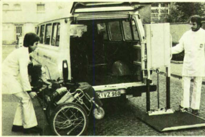
Bild links: Behutsam fährt der Helfer den Rollstuhl mit einer Schwerbehinderten bis an die Hebebühne. Rechts: Hydraulisch wird die Hebebühne bis auf die Ebene des Behinderten-Taxi angehoben.
