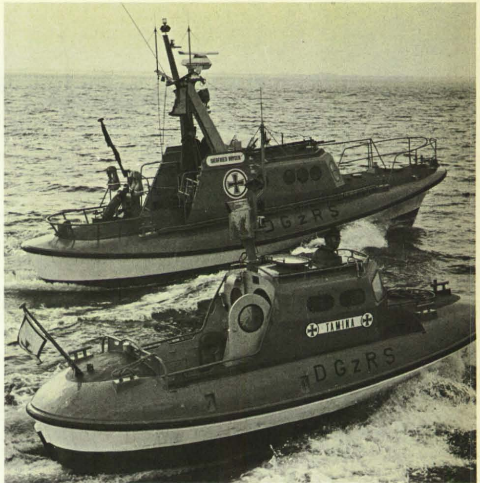
Bild oben: Strandrettungsboot „Siegfried Boysen“, 12,2 m lang, 3 m breit, 0,9 m Tiefgang, eine Schraube mit 240 PS, Geschwindigkeit 17 Knoten, ausgerüstet mit UKW-Sprechfunk und Radar. Liegeplatz: Neuuharlingersiel. Strandrettungsboot „Tamina“ (im Vordergrund) ist eines der Spezialboote für flache Küstengewässer und Wattgebiete. Unten: Seenotkreuzer „John T. Essberger“, 44,2 m lang, 8,05 m breit, 2,58 m Tiefgang, drei Schrauben mit insgesamt 7200 PS, Geschwindigkeit 30 Knoten, ausgerüstet mit Funk, Echolot, Radar, Funkpeiler, Selbststeueranlage, Feuerlösch- und Fremdenanlage sowie mit einem Hubschrauberdeck, Schwimmender Seenotkreuzer für den Ostseebereich; Tochterboot „Elsa“.
