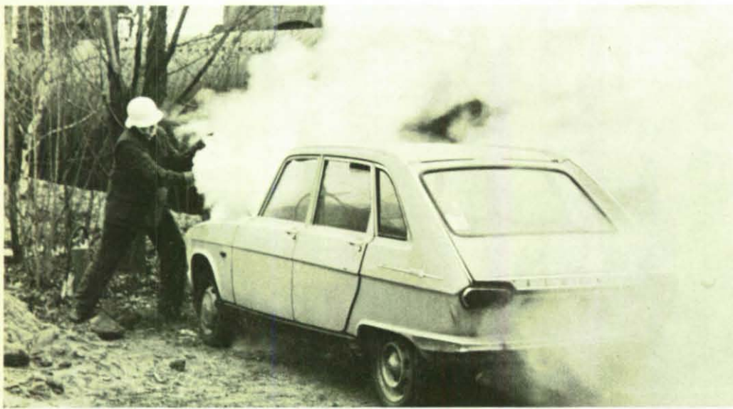
Mit einem Pulverlöschler ließ sich der Motorbrand bei einem verunglückten Fahrzeug in Sekunden löschen.
