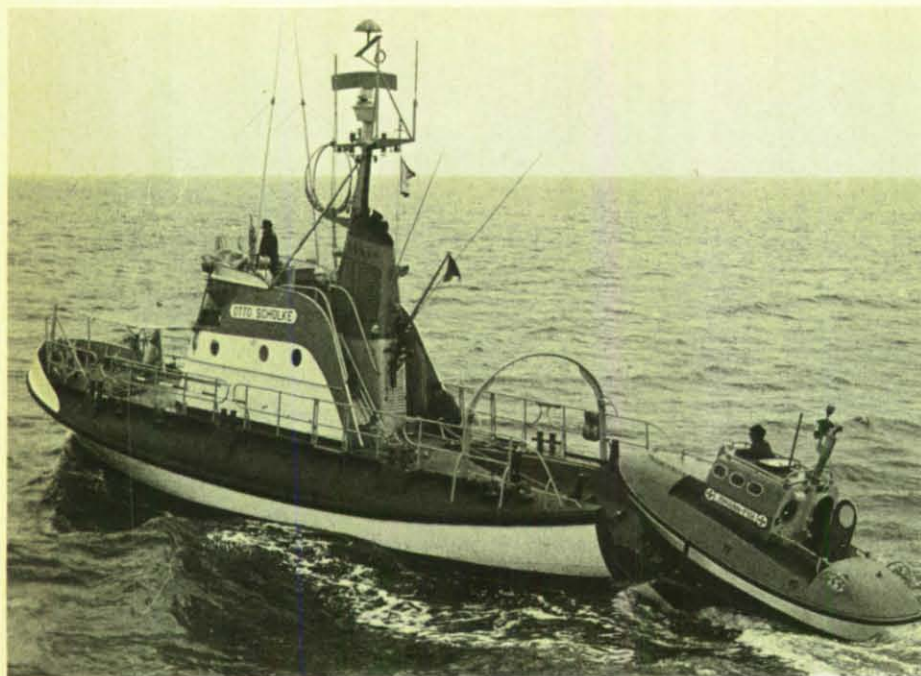
Seenotrettungsboot „Otto Schülke“, 18,9 m lang, 4,3 m breit, 1,25 m Tiefgang, eine Schraube mit 830 PS, Geschwindigkeit 18 Knoten, ausgerüstet mit Funk, Echolot, Radar, Sichtfunkpeiler, Kreiselkompaß, Selbststeuer-, Feuerlösch- und Fremdlanzanlage; Tochterboot „Johann Fidi“. Liegeplatz: Norderney, Hafen.
