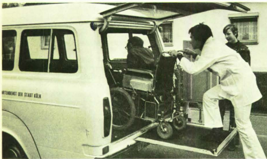
Die Einsteighöhe müßte höher sein. Zukünftige Fahrzeuge werden hinten Türen statt Klappen haben. Dennoch erfüllt auch dieser Fahrzeugtyp seinen Zweck, nämlich den Behinderten die Möglichkeit zu geben, am Arbeits- und Gesellschaftsleben teilzunehmen.
