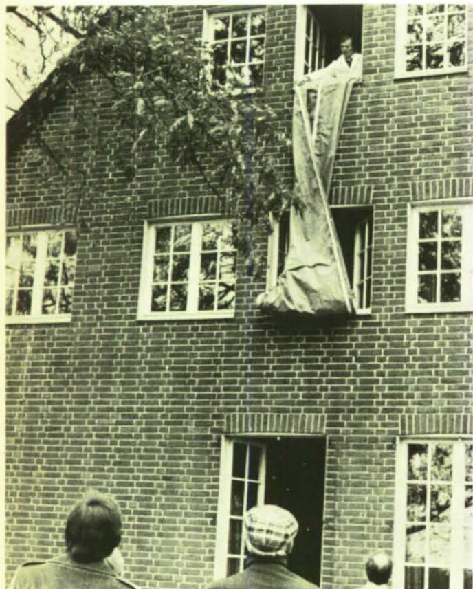
Bild links: In wenigen Sekunden ist die Rettungsrutsche einsatzbereit. Nachdem das Planenpaket durch das Ausstiegsfenster geworfen worden ist, entrollt sich die Bahn der Rettungs- rutsche. Rechts: An zwei Pfosten werden die Halteseile mit Karabinerhaken befestigt.
