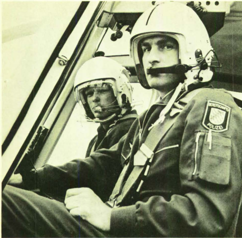
Sprechfunkverkehr aus der Luft. Bei den Hubschrauberpiloten bilden Helm und Sprechfunkgerät eine Einheit.
