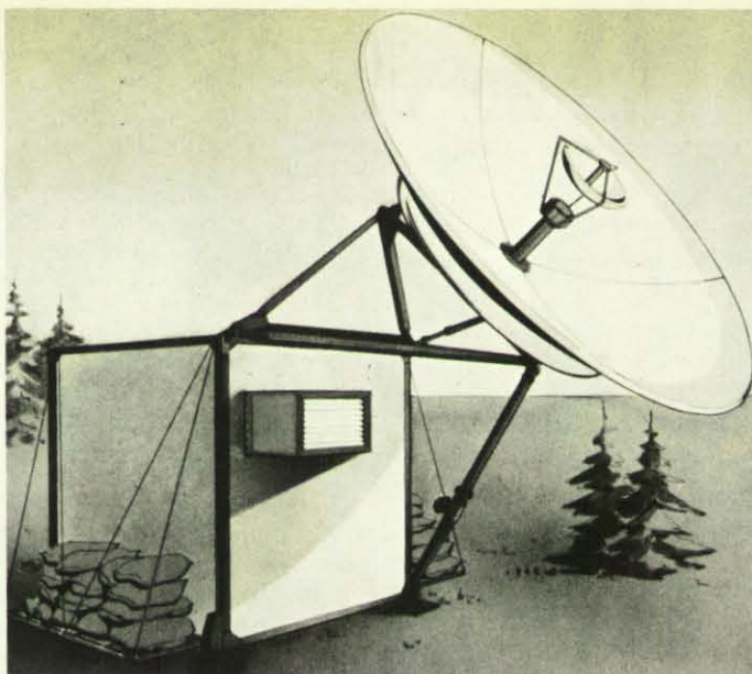
Schnell in Betrieb zu nehmen ist die transportable Erdefunkstelle, die in Kürze vom DRK übernommen und eingesetzt wird.
