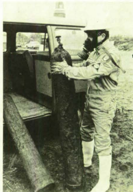
Links: Alle Verschlüsse dieser Chlorgasflasche – auch die Flasche selbst – sind stark korrodiert. – Rechts: Unter Beachtung aller Schutzmaßnahmen – Schutzanzug, Atemschutz – werden die stark zerfressenen Chlorgasflaschen abtransportiert.
