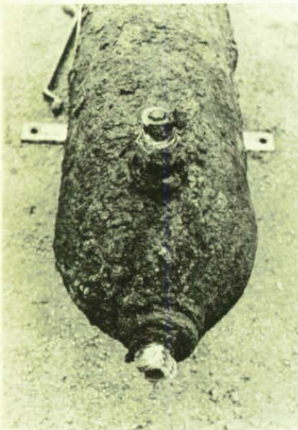
Links: Alle Verschlüsse dieser Chlorgasflasche – auch die Flasche selbst – sind stark korrodiert. – Rechts: Unter Beachtung aller Schutzmaßnahmen – Schutzanzug, Atemschutz – werden die stark zerfressenen Chlorgasflaschen abtransportiert.
