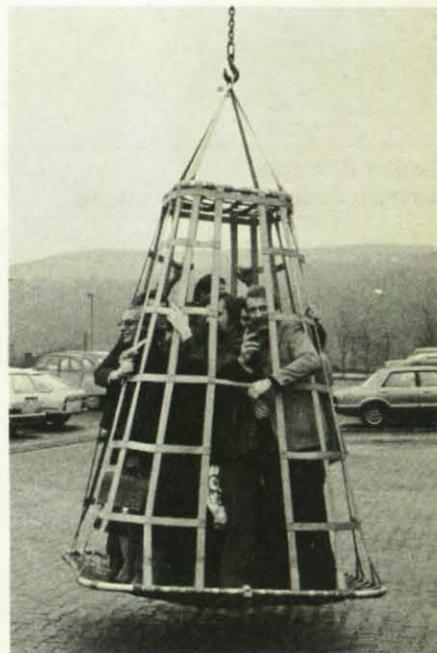
Das Rettungsnetz besteht aus einem unteren Rohrrahmen 1650x1650 mm mit stark abgerundeten Ecken. Der Rahmen hat Gelenke und ist zusammenklappbar. Der Rahmen ist mit einem dichten Netz von 45 mm breiten Nylon-Gurten versehen.
