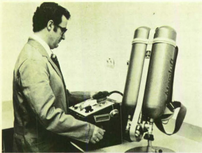
Teil der Atemschutzgerätekammer ist ein Spezialgerät zur Überprüfung von Lungenautomaten der Preßluftatmer. Vom sicheren Funktionieren aller Teile von Atemschutzgeräten hängen Leben und Gesundheit ihrer Träger ab.
