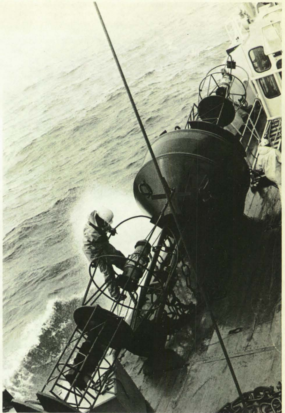
Schwer ist die Arbeit an Bord des Seezeichenfahrzeuges, das eine wichtige Aufgabe erfüllte. Die Erdgas-Pipeline auf dem Meeresgrund zwischen dem Ekofisk-Feld und Emden wurde mit Tonnen markiert.
