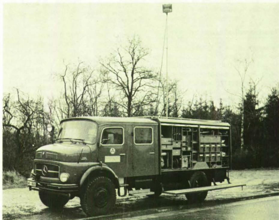
Blick auf die linke Fahrzeugseite des Gerätekraftwagen GKW 72, erste Fertigungsreihe. Hier ist der Teleskopmast ausgezogen und mit einem Licht-Fluter bestückt.
