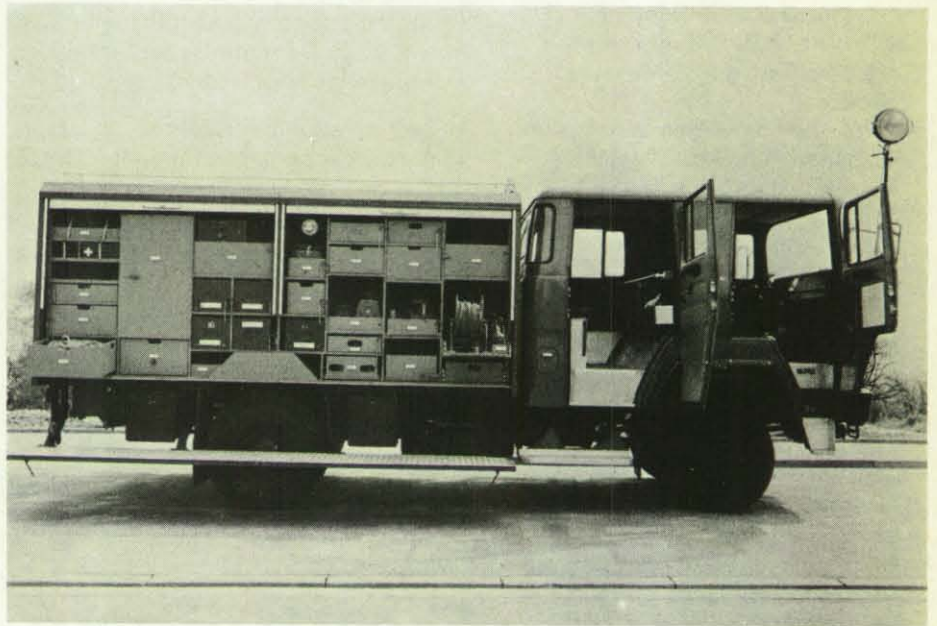
GKW 72, zweite Fertigungsserie, rechte Fahrzeugseite. Die Änderungen gegenüber der ersten Fertigungsserie basieren u. a. auf den damit gewonnenen Erfahrungen und auf taktischen Überlegungen.
