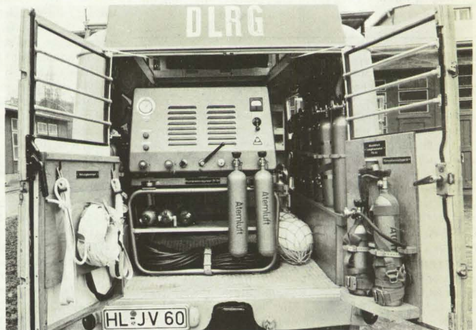
Das „Innenleben“ eines modernen Rettungswagens der DLRG. Kompressor zum Auffüllen der Tauchflaschen, Rettungsbälle und Rettungsleinen gehören zu den wichtigsten Ausrüstungsgegenständen.
