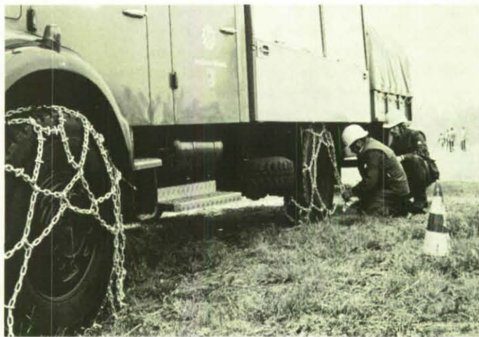
Auch das Auflegen der Gleitschutzketten will gelernt sein; vor allem, wenn man unter Zeitdruck steht.
