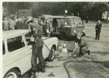
Demonstration einer Bergung aus einem Unfallauto. Die Stahlrahmen der Karosserie werden mit der hydraulischen Unfallrettungsschere durchgeschnitten.
