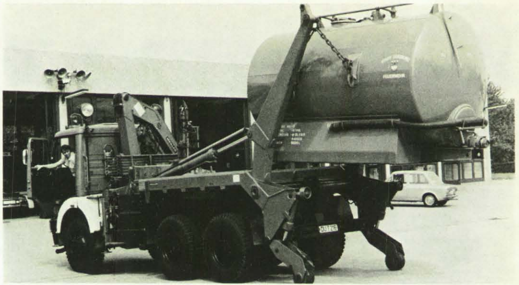
Der Vorläufer dieser Technik war ein System, das von der Industrie für Müllfahrzeuge konstruiert worden war und bei der Duisburger Feuerwehr unter anderem für Löschwassertanks (unser Bild) Verwendung fand.
