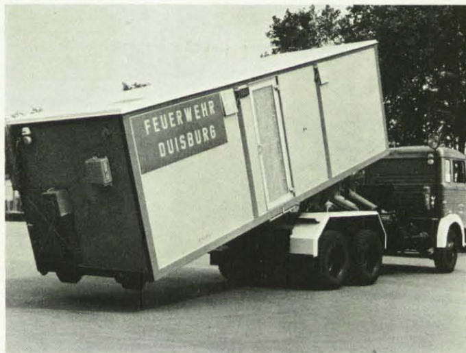
In diesem Container-„Haus" wird bei Großeinsätzen die Einsatzleitung installiert. Außerdem können Obdachlose kurzzeitig darin untergebracht werden.
