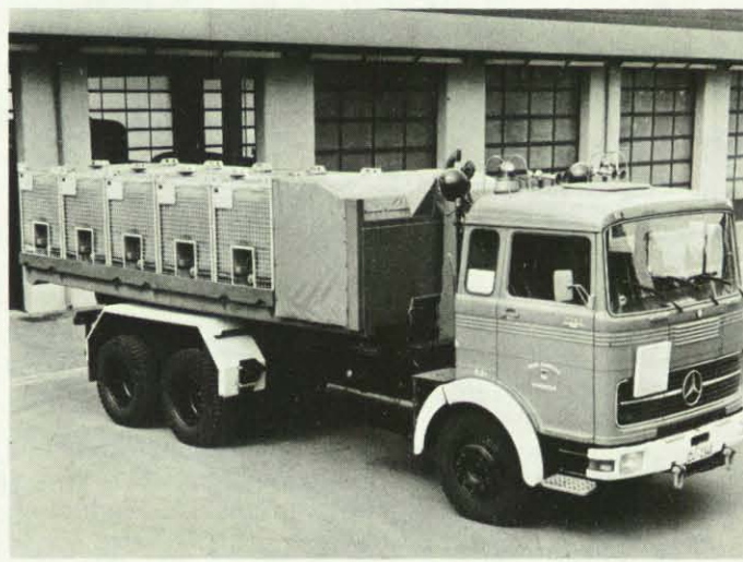
Aggressive Flüssigkeiten kann dieser Container aufnehmen. Behältnisse für insgesamt 8000 Liter wurden auf einem Container-Aufsatz zusammengefaßt.
