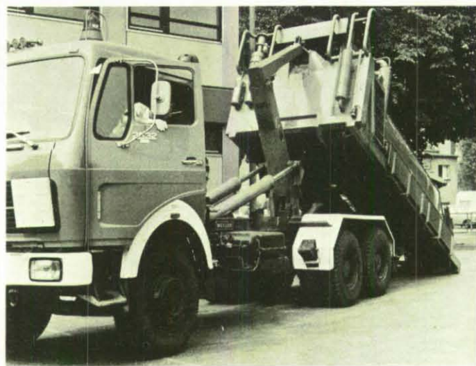
So funktioniert das Container-System: Ein Hebearm greift in die Stahlöse an der Vorderfront des Containers, der dann auf das Fahrzeuggestell gezogen wird.
