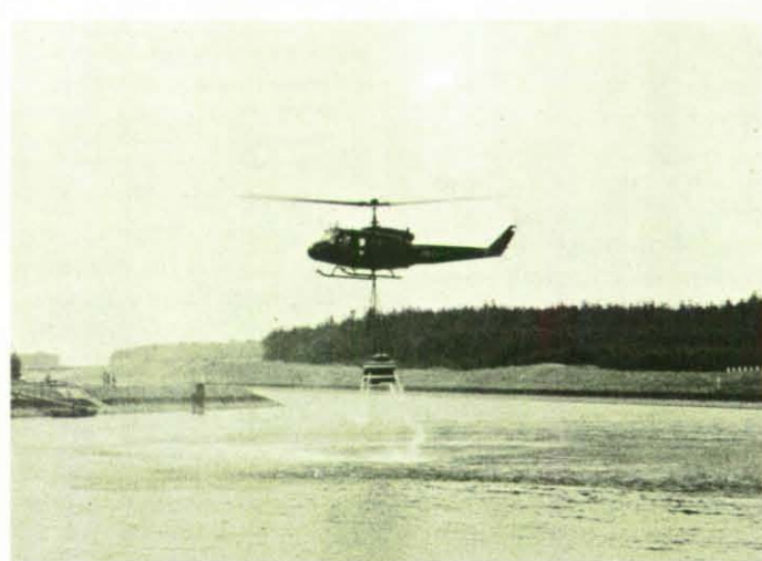
Nach dem Eintauchen des Behälters (Mindesttiefe 2 m) hebt der Hubschrauber ab. Dabei läuft die Überlast ab.
