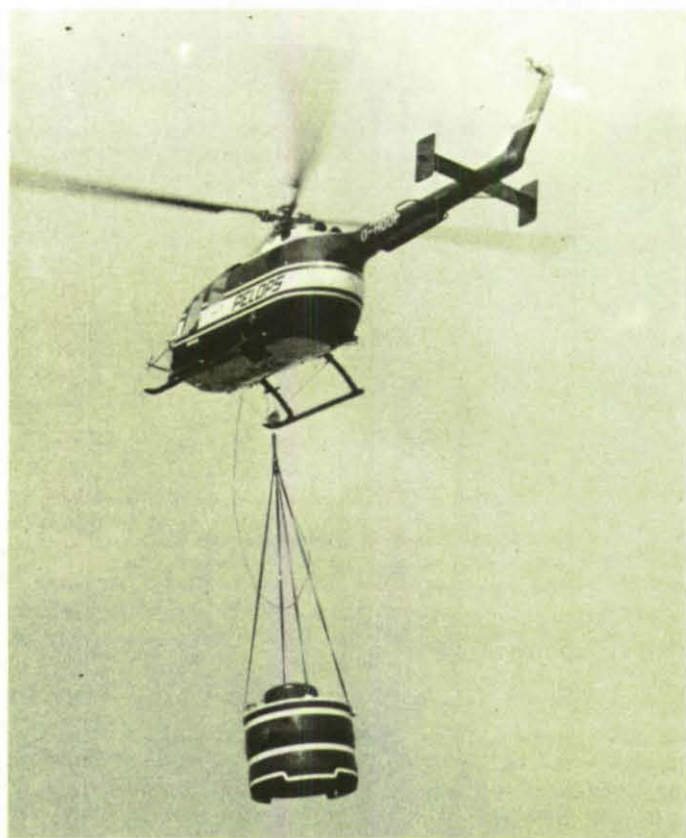
Löschwasserbehälter als Außenlast für Hubschrauber haben sich in der Vergangenheit bei Waldbränden in verschiedenen Ländern bewährt. Unser Bild: Der 1500-l-Kunststoffbehälter SMOKEY II mit Überlastöffnungen am Lasthaken einer Bo 105.
