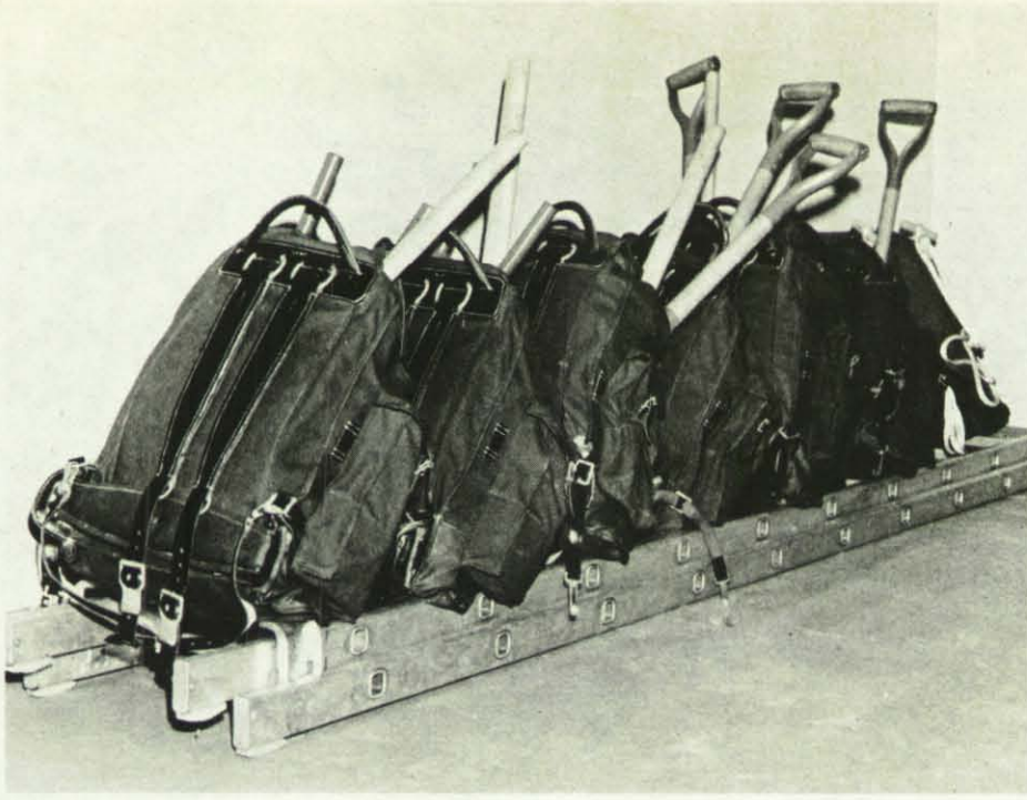
Teile der Fachdienstausstattung werden in Rucksäcken einsatzbereit aufbewahrt.
