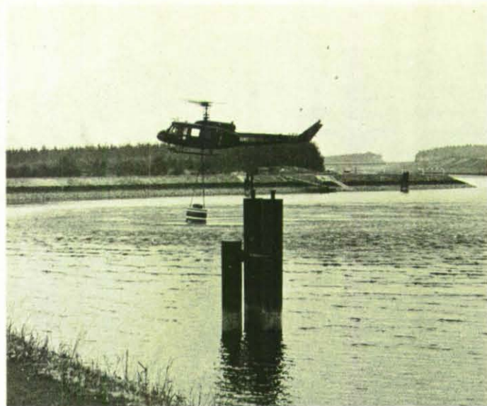
Anflug mit einem BGS-Hubschrauber vom Typ Bell UH 1 D zum Eintauchen des Löschwasserbehälters SMOKEY II (1500 l).
