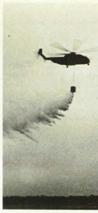
Flächendeckendes Abregnen wird im Vorwärtsflug bei einer Geschwindigkeit von ca. 100 Knoten erreicht.
