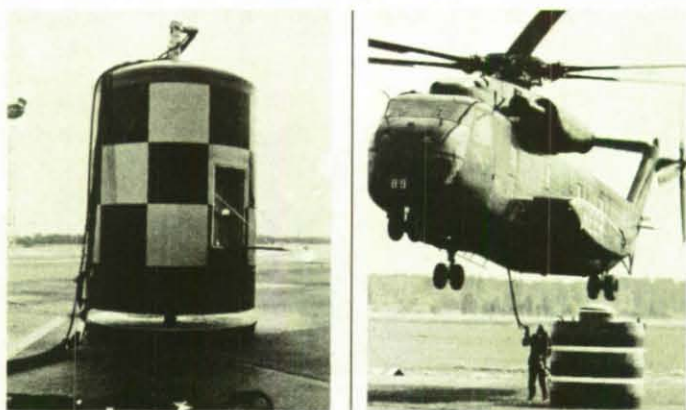
Links: Dieser Löschwasserbehälter QD aus Stahl wurde zunächst mit einer Füllmenge von 3800 l angeboten. Durch die Verwendung einer Aluminium-Legierung konnten zugunsten der Füllmenge Gewichtseinsparungen erzielt werden. – Rechts: Hier befestigt ein Feuerwehrmann einen Kunststoffbehälter SMOKEY I mit 5000 l Fassungsvermögen am Lasthaken eines schwebenden Hubschraubers vom Typ CH 53.
