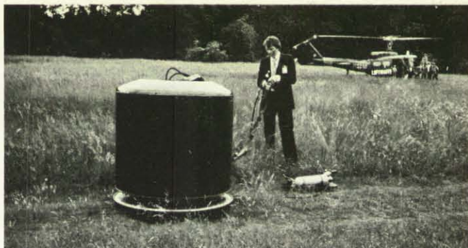
Das Fassungsvermögen dieses Alu-Behälters beträgt 1500 l. Durch hydraulische Steuerung kann der Mantel angehoben werden, wodurch ein flächenförmiges Abregnen erreicht wird.
