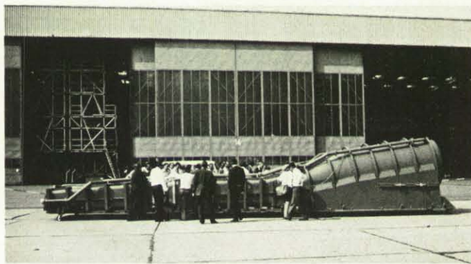
Eine bemerkenswerte Entwicklung: Der 13,80 m lange Feuerlösch-Rüstsatz für das Transportflugzeug C-160 TRANSALL. Das Leergewicht beträgt 2100 kp.
