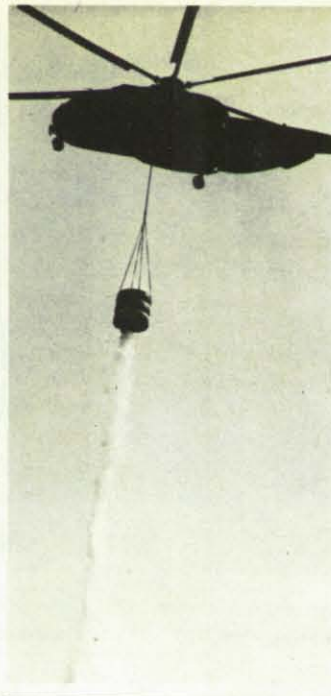
5000 l Wasser werden in Sekundenschnelle punktuell abgeregnet.
