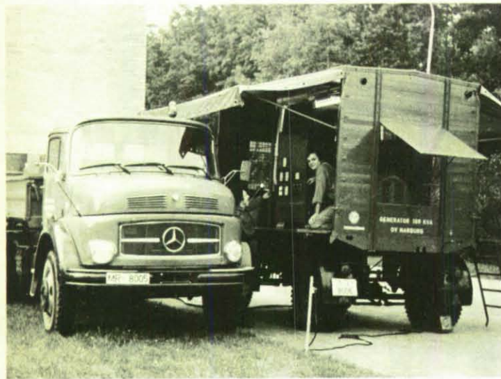
Der neue 100-kVA-Generator des OV Marburg wurde jetzt zum ersten Male eingesetzt.
