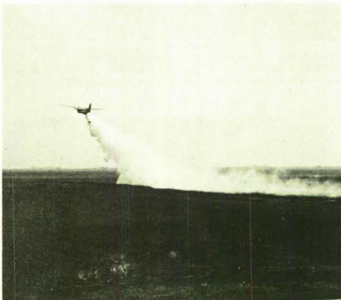
Durch Hochziehen der Maschine und Vergrößerung des Anstellwinkels wird das Auslaufen des Wassers beschleunigt.
