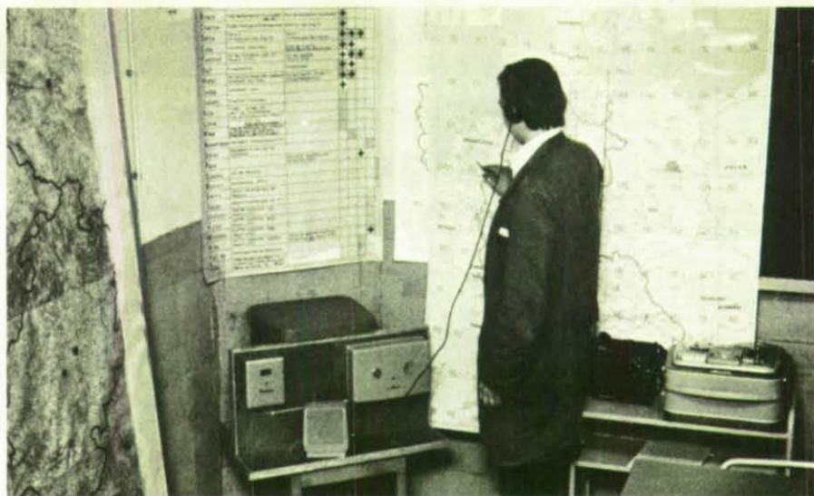
Auswertung der Warnstellenreportage in einer WD-Leitmeßstelle. Links im Bild die Warnstelleneinrichtung, rechts Rundfunkgerät und Tonbandaufzeichnung.
