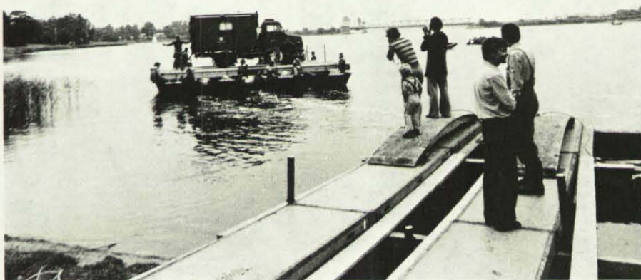
Mit der 8-t-Fähre wird ein MKW über die Schlei übergesetzt.
