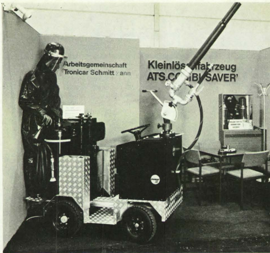
Unser Bild zeigt den Prototyp des ATS-Combi-Saver, ein Löschfahrzeug, das die Lücke zwischen den trag- und ziehbaren Feuerlöschgeräten und den bisher bekannten Löschfahrzeugen ausfüllen soll.
