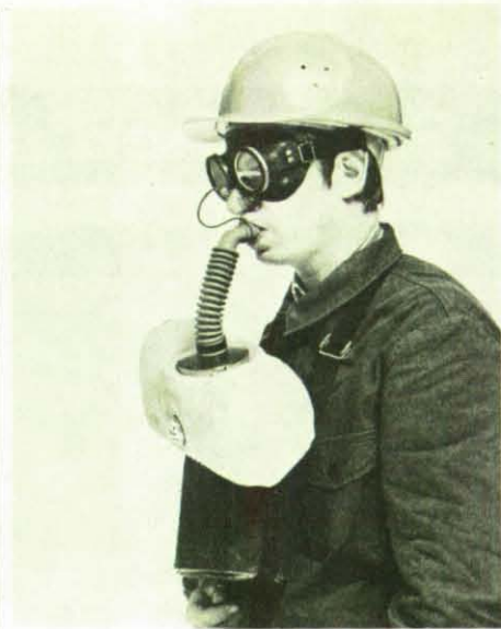
Der Sauerstoffselbstretter SSR 90 versorgt seinen Träger auch bei extremer Belastung bis zu 90 Minuten mit Sauerstoff, der aus einem Chemical entwickelt wird.
