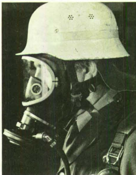
Unter Verwendung neuer Materialien wurde ein Lungenautomat entwickelt, der wesentlich leichter und kleiner als die herkömmlichen Lungenautomaten ist.
