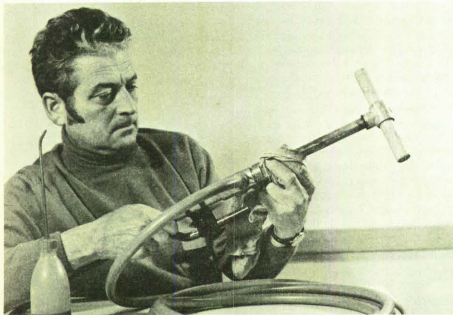
Eine vierteljährliche Funktionsprüfung wird für Kleinlöschgeräte – Kübel- und Einstellspritze – empfohlen. Die Kolbenstange der Geräte ist leicht einzufetten.
