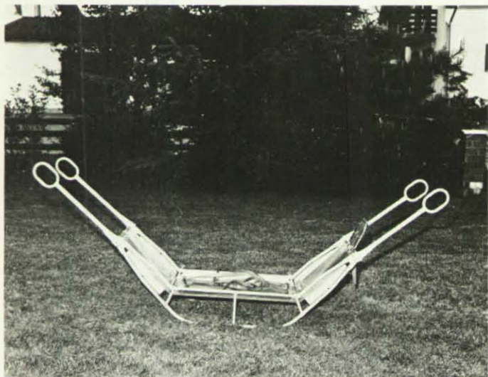
In dieser Stellung wird die Bergtrage, von der es bisher nur diesen Prototyp gibt, zum Abseilen im Steilgelände benutzt. Der Verletzte wird dabei in Semiflexion gelagert.
