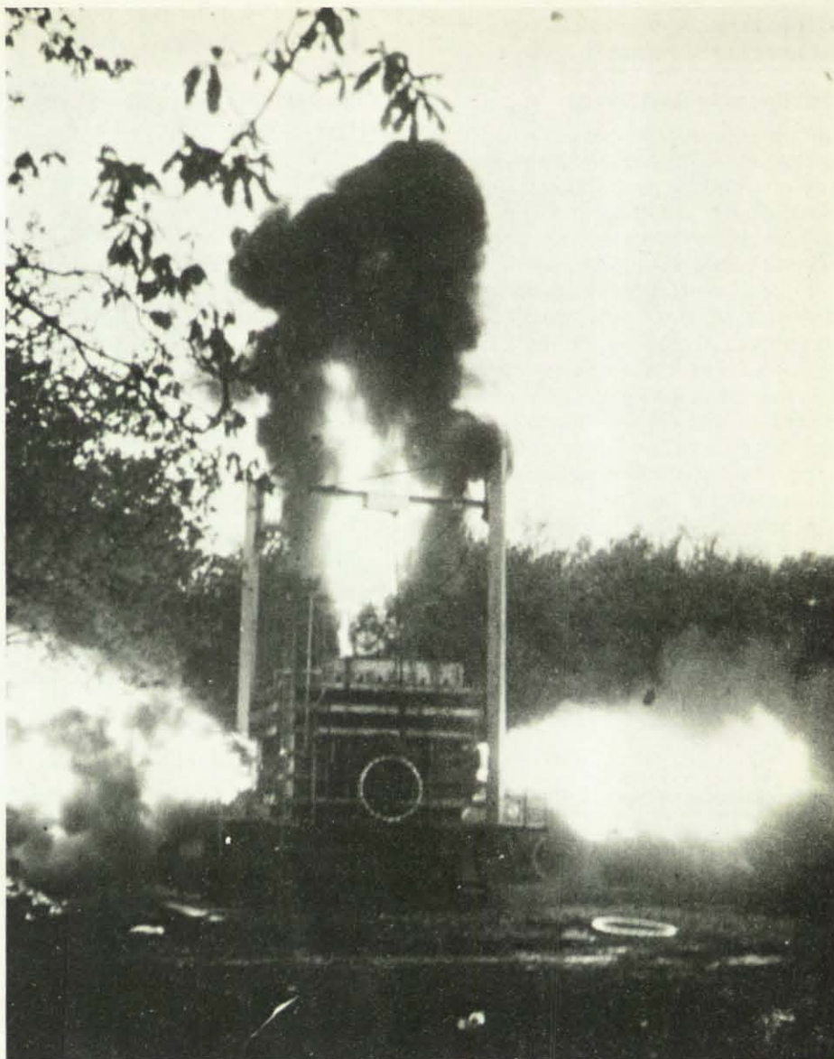
Eine zu wissenschaftlichen Zwecken herbeigeführte Staubexplosion an einem Druckentlastler (30-m 3 -Behälter).
