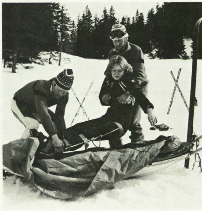
Eine verletzte und schon versorgte Skiläuferin wird auf einen Akja gelegt. Das ist eine Art bootsförmiger Rettungsschlitten mit je zwei starr befestigten Metalldeichseln. Mit Kunststoff überzogene Schaumgummimatten sorgen für eine bessere Lagerung. Ein speziell entwickelter Thermosack dient als Kälteschutz.
