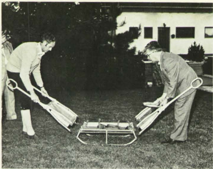
Zu den Aufgaben der Bergwacht gehört auch die Weiterentwicklung von Bergrettungsgeräten. Unser Bild zeigt die Neuentwicklung einer Gebirgstrege. Sie ist dreiteilig zum Zwecke der besseren Gewichtsverteilung beim Tragen.
