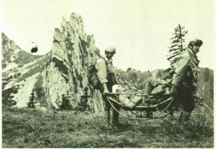
Diese Gebirgstrage ist das meistgebrauchte Abtransportgerät im Sommer und in schneefreiem Gelände. Mit ihr kann der Verletzte aus steilstem Felsgelände abgeseilt werden. Bei nicht zu steilem Gelände wird die Trage bei entsprechender Sicherung auf die Schleifkufen gesetzt und wie ein Schlitten gefahren.
