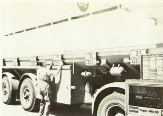
An diesem Mehrkammer-Tankfahrzeug befinden sich an der Längsseite für jede Kammer orangefarbene Tafeln mit der Kennzeichnungsnummer für den in der jeweiligen Kammer transportierten Stoff. Der Fahrer ist damit beschäftigt, die (auswechselbare) Kennzeichnungsnummer für die neue Ladung einzusetzen.
