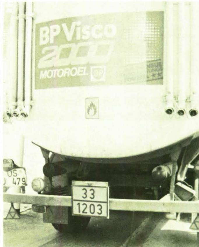
Die orangefarbene Warntafel, hier auf der Rückseite eines Fahrzeugs, trägt bei Tankfahrzeugen seit Ende 1976 Kennzeichnungsnummern. Sie zeigen in diesem Falle an: die Stoffkennzahl 1203 für Kohlenwasserstoffe mit Flammpunkt unter 21° C (untere Zelle) und die (verdoppelte) Kennzahl 3 der Hauptgefahr (entzündbarer flüssiger Stoff), wobei die Verdoppelung auf die in dem niedrigen Flammpunkt liegende Erhöhung der Hauptgefahr hinweist.
