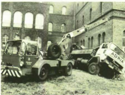
Der 6-t-Kran des THW-Landesverbandes Berlin hat den 16-t-Lkw „am Haken“ und stellt ihn wieder auf die Räder.
