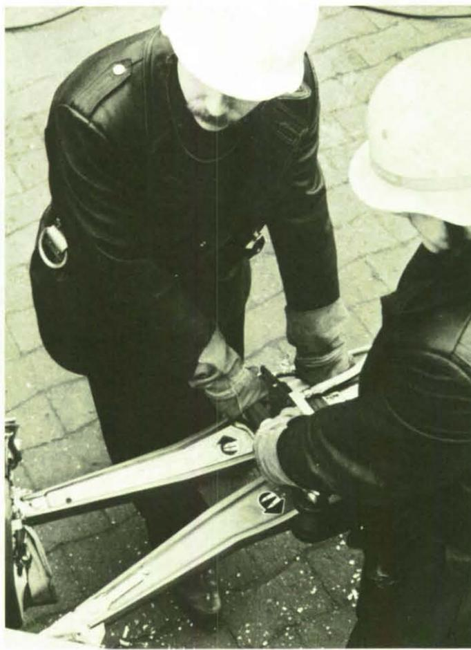
In funkenloser Arbeitsweise können mit dem Spreizer zur Rettung eingeschlossener oder eingeklemmter Unfallopfer Fahrzeugtüren aufgesprengt, Lenksäulen weggezogen oder Fahrzeugdächer hochgedrückt werden. Funktion und Handhabung solcher und ähnlicher Geräte lernen die Feuerwehrleute an ihren Feuerweherschulen kennen.
