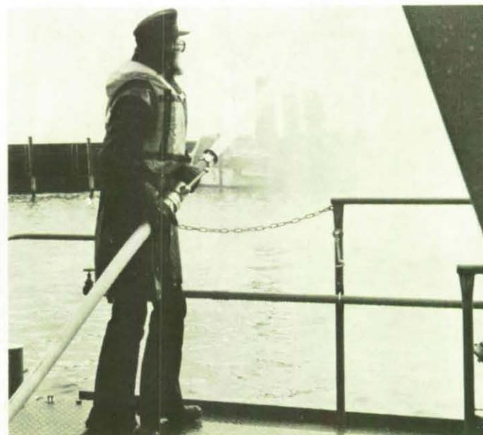
Zu der feuerwehrtechnischen Ausstattung eines „SÖG“ gehört auch eine Feuerlöschkreiselpumpe, mit der Ölbindemittel ausgebracht werden können.
