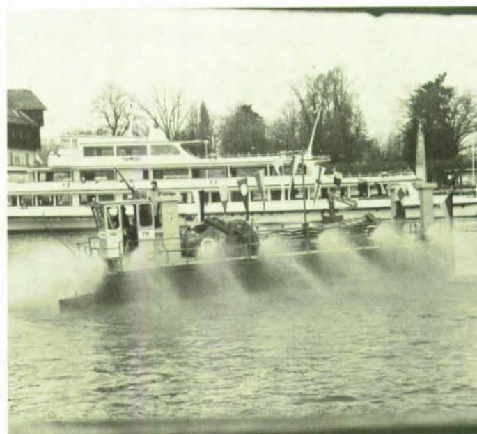
In Gefahrensituationen, z. B. bei einem Flächenbrand, kann zum Schutze von Besatzung und Schiff eine Selbstberieselungsanlage eingeschaltet werden.
