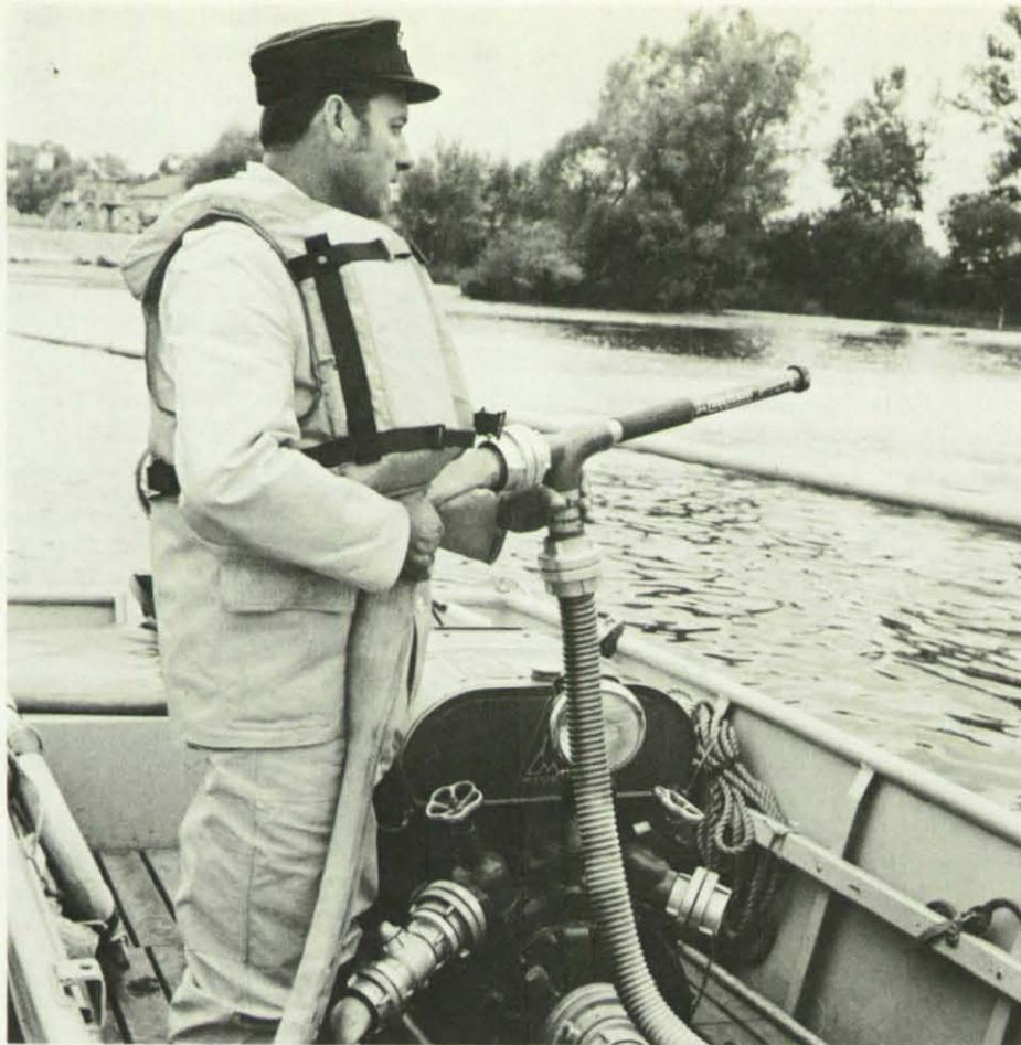
Unser Bild zeigt eine für das Ausbringen von Ölbindern auf ein Arbeitsboot montierte Feuerlöschpumpe mit einem Spezialrohr, dem sog. „Streubläser“.
