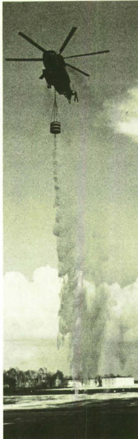
Der Löschtank in Aktion: Innerhalb von 14 Sekunden kann der Behälter mit 5 000 Liter Fassungsvermögen geleert werden.
