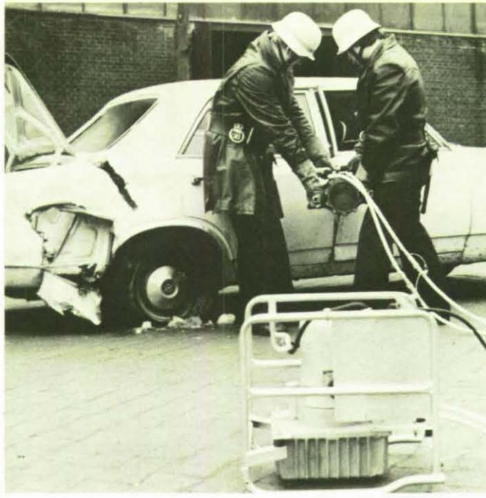
Für die technische Hilfeleistung, insbesondere im Bereich des Rettungswesens, benutzt die Feuerwehr u. a. diesen Spreizer, ein hydraulisch betätigtes Rettungsgerät, das durch ein Hydro-Pumpenaggregat angetrieben wird.
