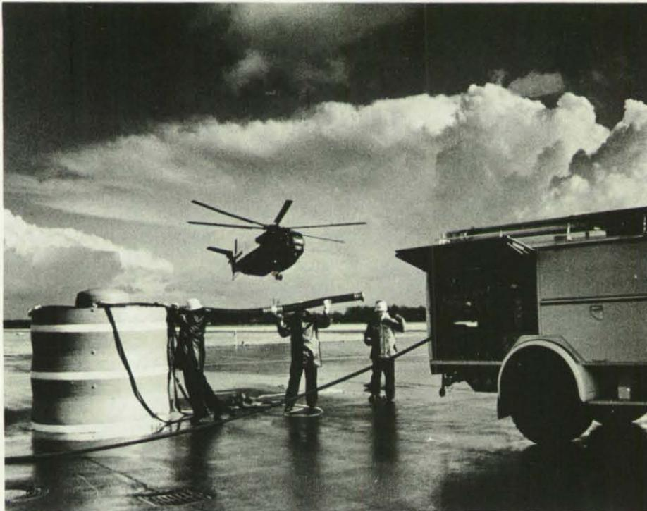
Speziell bei Wald-, Moor- und Heidebränden soll in Zukunft das Feuer auch aus der Luft bekämpft werden. Dieser Tank hat ein Fassungsvermögen von 5 000 Litern und wird an einen Hubschrauber gehängt. Insgesamt sollen 13 große und 13 kleine Behälter (Inhalt 1 500 Liter) für das Land Niedersachsen angeschafft werden.
