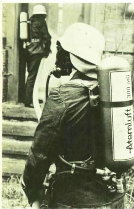
Bei Rettungsmaßnahmen, wie im nebenstehenden Beitrag beschrieben, erfüllen Atemschutzgeräte einen hervorragenden Dienst gegen Atemgifte. Unser Bild zeigt den Einsatz von Preßluftatmern.
