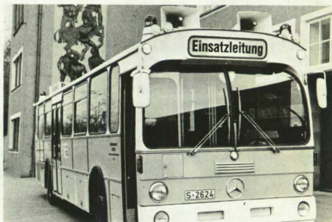
Dieser Katastropheneinsatzleitwagen (KELW) dient bei Katastrophen und Großeinsätzen dem Katastropheneinsatzleiter oder der Technischen Leitung als mobile Leitstelle.
