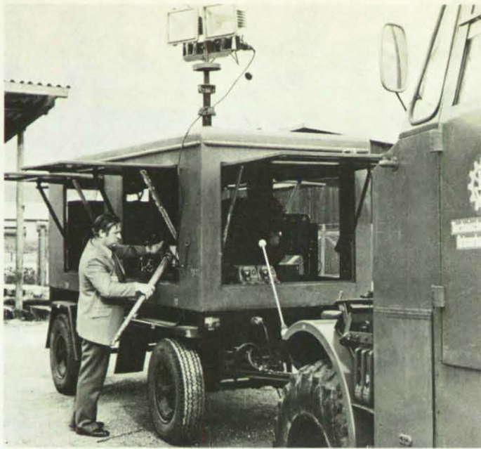
Der Ortsverband Stuttgart des Technischen Hilfswerks hat in seiner Betriebsstelle seine Unterkunft, Schulungs- und Geräte-räume etc. Zu seiner Ausrüstung gehört auch dieses fahrbare Notstromaggregat.
