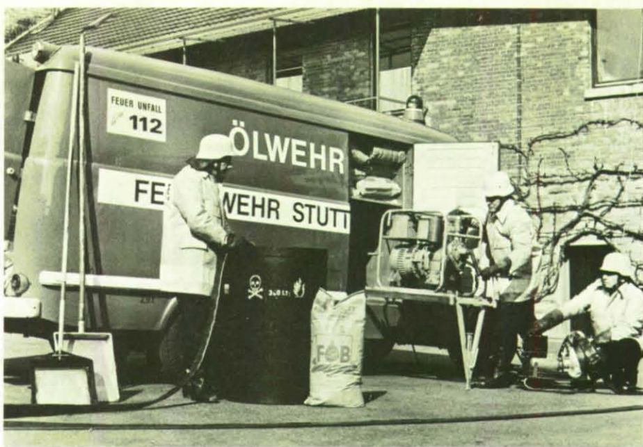
Die Ölwehr ist ein wichtiger Bestandteil des Katastrophenschutzes. Das Fahrzeug vom Typ GW-Öl, geeignet für kleinere und mittlere Ölunfälle, ist eines der meisteingesetzten Fahrzeuge der Feuerwehr. Unser Bild zeigt die Demonstration der Geräte.
