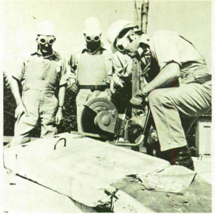
Einsatz der Trennscheibe des Bergungs-Mehrzweckgeräts. Dabei schreiben die Sicherheitsbestimmungen vor, daß Schutzhelm, Schutzbrille und Schutzhandschuhe zu tragen sind.
