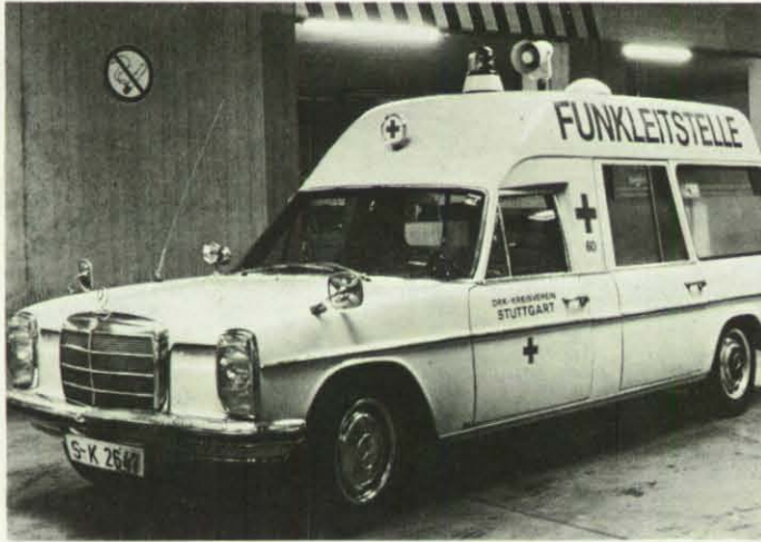
Die mobile Funkleitstelle des DRK-Kreisvereins Stuttgart ist mit drei FuG 7b, einer Feldvermittlung und einigen Feldtelefonen ausgerüstet.
