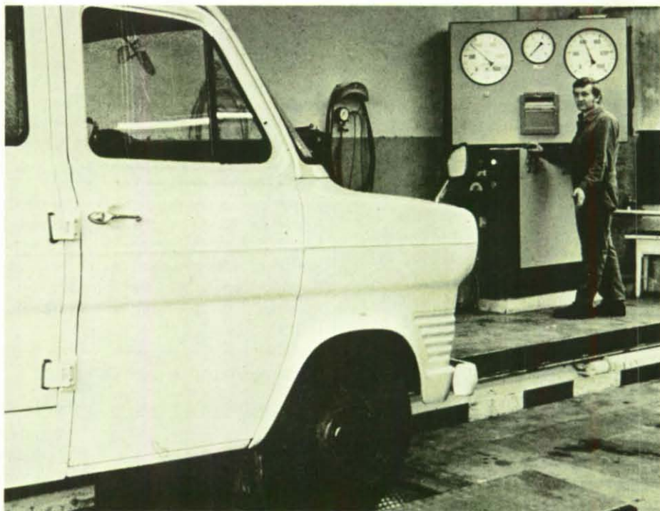
Auf den Armaturen des Bremsrollenprüfstandes läßt sich die Bremskraft jeder einzelnen Bremse und die Pedalkraft – gemessen in kp – ablesen.
