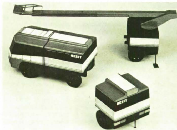
O.R.B.I.T. auf einen Blick: Basisfahrzeug, Ergänzungseinheit (vorn) und Hubrettungseinheit.
