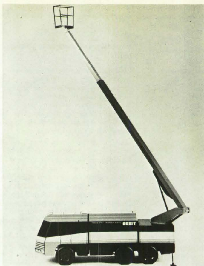
Hubrettungs-Ergänzungseinheit in Einsatzstellung.
