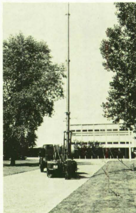
Einen markanten und weithin sichtbaren Blickpunkt auf dem Messegelände bildete der Berliner THW-Mastkraftwagen mit ausgefahrenem 30-m-Mast.
