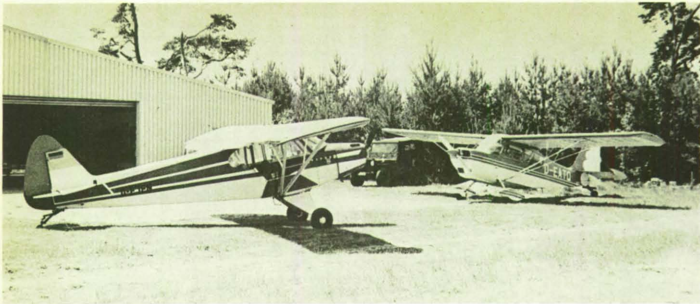
Kurzstartende Flächenflugzeuge, hier v. l. eine Piper Pa 18 und eine Ballanca Citabria, sind zuverlässige und billige Beobachtungsplattformen für die Luftbeobachtung. In Bayern sind z. Z. 20 Flächenflugzeuge für den Einsatz von FuG 7b-Geräten vorgerüstet.
