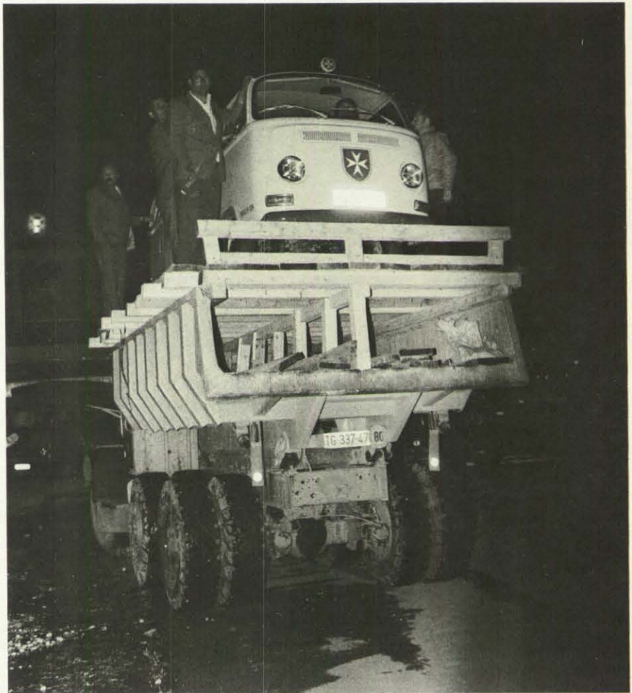
Mit einem massiven Bretteraufbau auf einem Lkw wurde in Titograd eine Entlademöglichkeit für die mobile Trinkwasseraufbereitungsanlage geschaffen.
