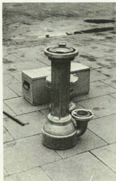
Strahlgerät (Tiefsauggerät) mit Saugkorb, ohne Rücklaufverhinderer.
