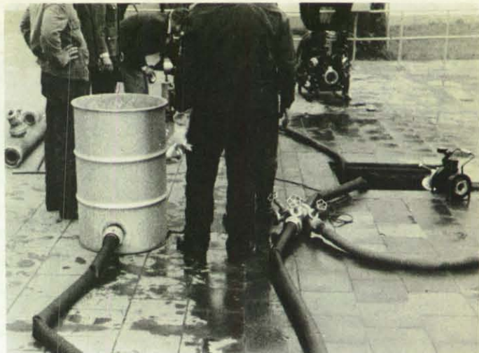
Füllwasserkessel im Nebenschluß angeschlossen.
