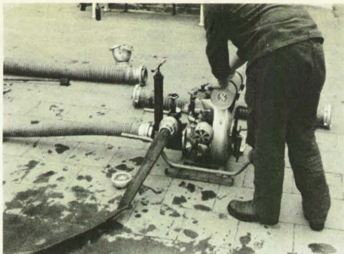
Betrieb mit einer TS 4-Wasserstrahlpumpe.
