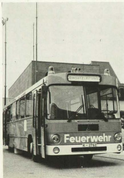
vom Typ L 117 mit serienmäßiger Luftfederung, dessen Motor 171 kW (232 PS) leistet, die Höchstgeschwindigkeit beträgt ca. 110 km/h. Mehr als 10 km Leitungen versorgen und verbinden die vielen Funk-, Telefon- und Elektronikgeräte. Gesamtwert dieser rollenden Kommando-Zentrale: über 325 000 DM.
