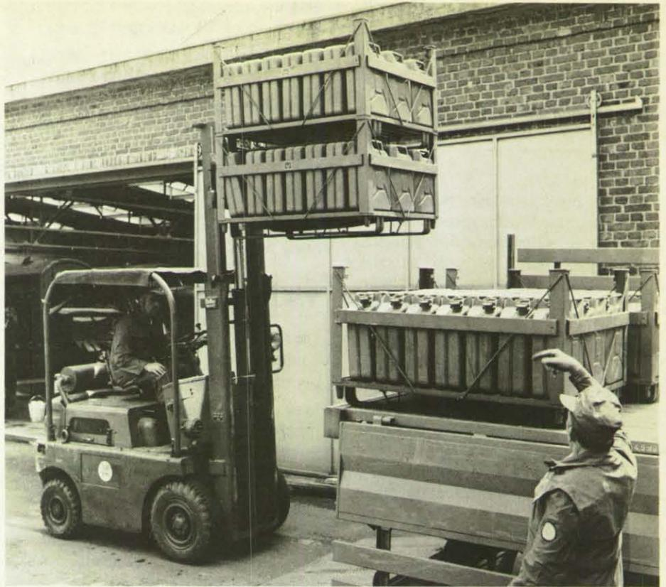
Verladen von Betriebsstoff in Einheitskanistern, Stahl, 20 l.
