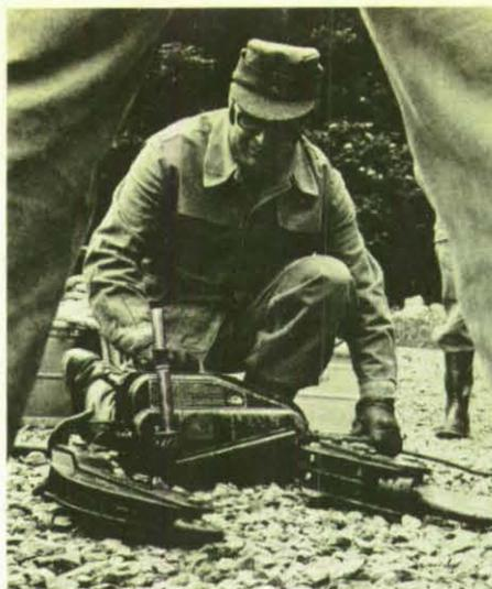
Der Greifzug, ebenfalls ein Gerät der Bergung, ist ein Handhebezeug mit Drahtseilzug, das in der Zuglänge praktisch unbegrenzt und in jeder Richtung horizontal, schräg, vertikal – mit gleicher Sicherheit eingesetzt werden kann. Nur wer den Umgang damit erlernt hat, kann das Gerät sicher bedienen.
