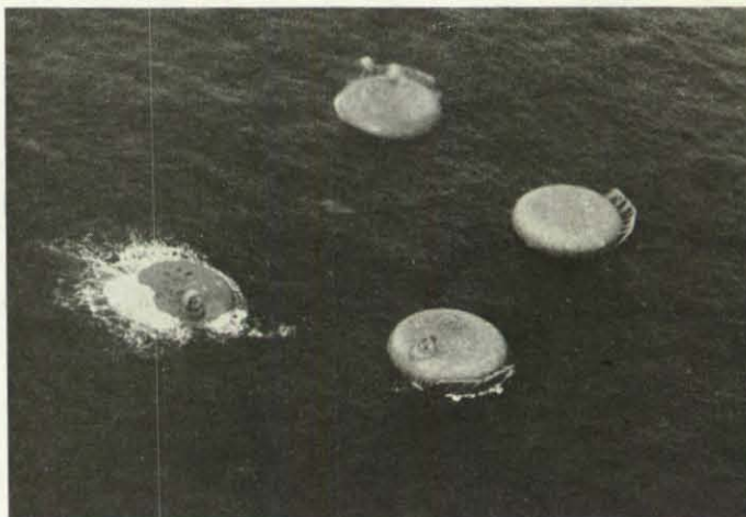
Aus bisher nicht geklärter Ursache brach während eines Sturmes einer der fünf Ponton-Pfeiler der Hotelinsel „Alexander Kielland“ und brachte die Insel zum Kentern. Unser Bild zeigt den Pfeiler unmittelbar nach dem Unglück.
