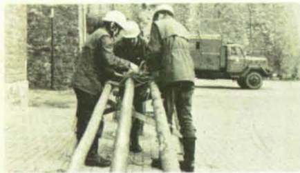
Abschlußprüfung in Hildesheim: Binden eines Dreibockbundes.
