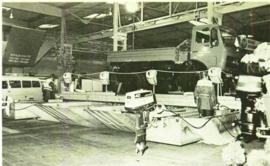
Für die Rettung aus Wassergefahren: eine 8-t-Pontonfähre aus unsinkbaren Aluminium-Pontons, von den OV Nienburg und Hameln errichtet.
