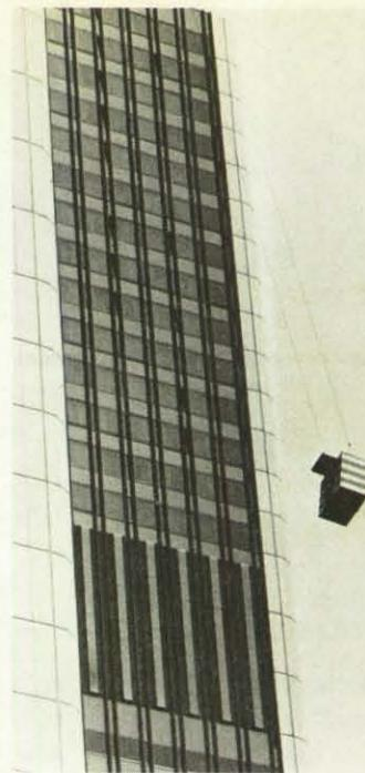
Einsatzort geführt werden. Dort wird zur Erleichterung der Rettungsaktion eine klappbare Einstiegbrücke ausgefahren. Sie dient einmal der Sicherheit der Seilbühne selbst (Turbulenzen etc.), zum anderen verhindert sie weitgehend den Blick nach unten: Verminderung oder Verhinderung von Höhenangst und von Panik der zu rettenden Personen.
