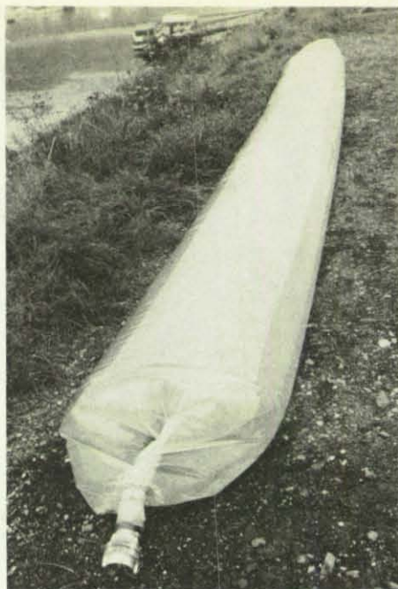
Bild 10: Schlauchfolie mit Einfüllstutzen für ölverunreinigtes Wasser.
