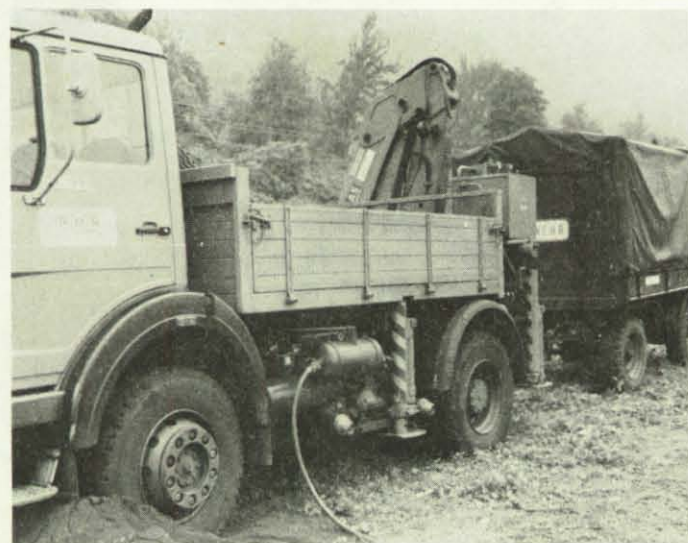
Bild 7: Aus einem Kraftfahrzeug ausgefahrenes Gerät zur Ölaufnahme von der Wasseroberfläche: Eine oder mehrere Kordeln aus Kunststoff-Fasern mit hoher Ölaufnahmefähigkeit werden über das ölverunreinigte Wasser gezogen, dabei wird das schwimmende Öl von den Kordeln nach Art eines „Mops“ aufgenommen, im Gerät zwischen umlaufenden Walzen ausgepreßt und zurückgewonnen.
