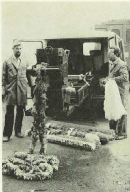
Bild 7: Aus einem Kraftfahrzeug ausgefahrenes Gerät zur Ölaufnahme von der Wasseroberfläche: Eine oder mehrere Kordeln aus Kunststoff-Fasern mit hoher Ölaufnahmefähigkeit werden über das ölverunreinigte Wasser gezogen, dabei wird das schwimmende Öl von den Kordeln nach Art eines „Mops“ aufgenommen, im Gerät zwischen umlaufenden Walzen ausgepreßt und zurückgewonnen.
