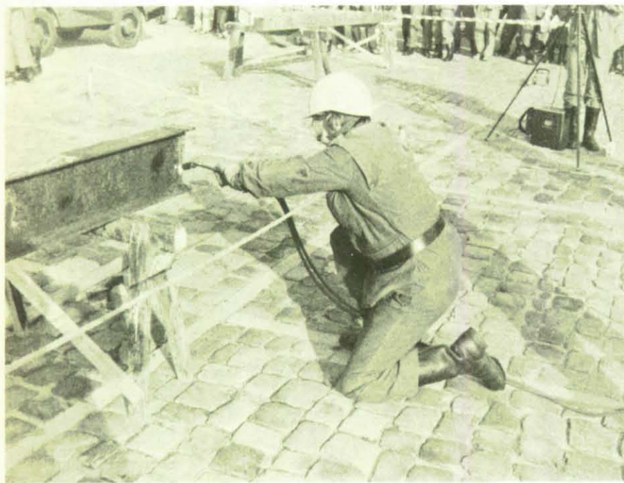
Besonderes Können verlangt das Brennschneiden. Ein glatter Schnitt und Schnelligkeit waren maßgebend für die Zahl der Punkte.
