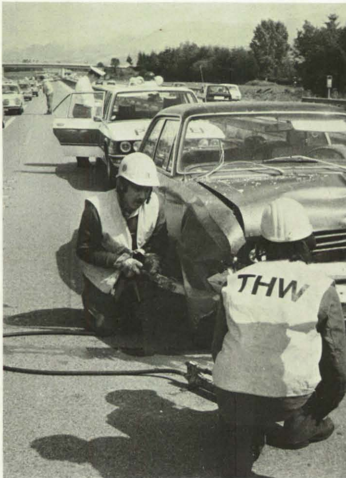
Als besonders wirksam erweist sich der Rettungsspreizer. Mit ihm werden eingedrückte Kotflügel ausgebeult, damit die Pkw ihre Fahrt fortsetzen können.
