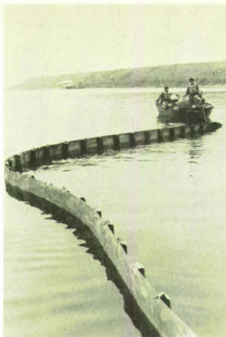
Bild 5: Ausziehen einer Iteecran-Ölsperre auf dem Wasser mit Außenbord-Motorboot bei der Einsatzübung. Die Sperre besteht aus gegen Mineralöle und Lösungsmittel beständigem, PVC-beschichtetem Polyestergewebe mit Schwimm-taschen, aus Einzellängen von 10 m und 20 m zusammensetzbar; Gewicht nur ca. 2 kg/m.
